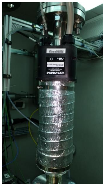
Slika 4.20 Grijač zraka Sylvania SureHeat Max
