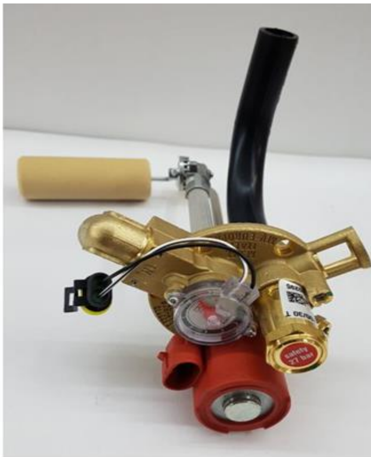
Slika 7. Prikaz multiventila za UNP
