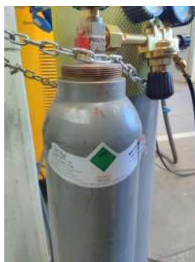
Slika 20. Mješavina zaštitnog plina Ar 75,5 % i CO<sub>2</sub> 2,5 %
