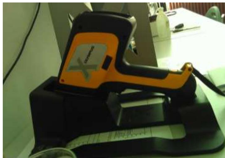
**Slika 27.      XRF uređaj za ispitivanje kemijskog sastava materijala**
