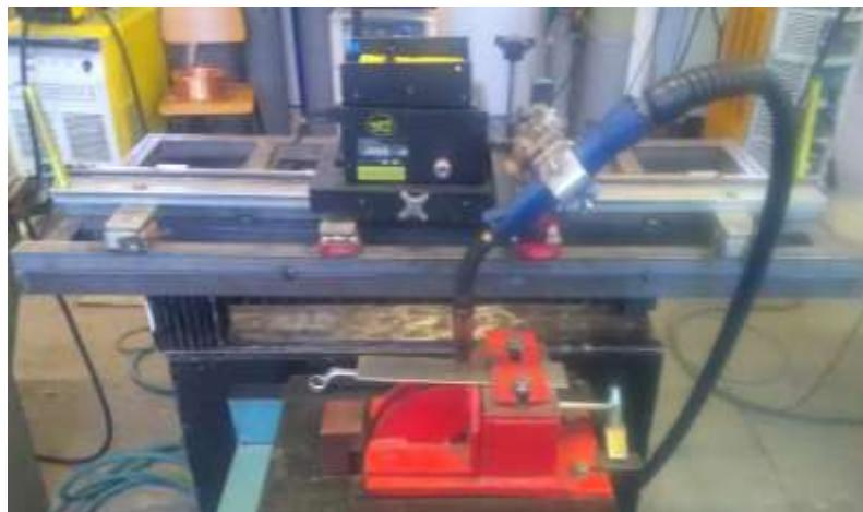
Slika 19. „Bugo“ sustav za automatizaciju MIG/MAG zavarivanja
