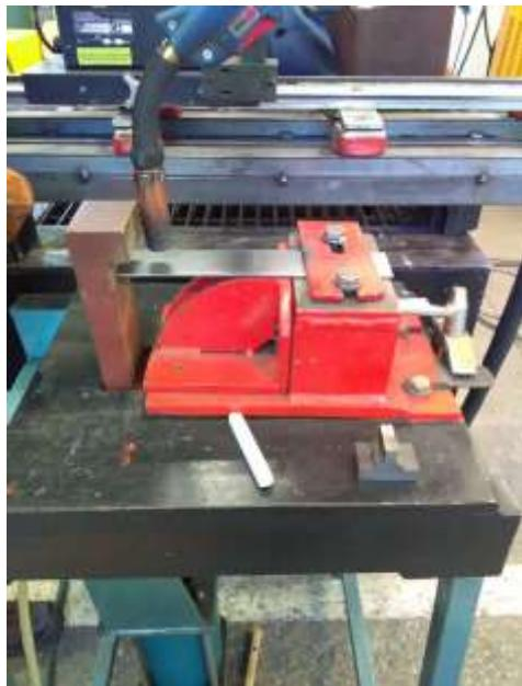
**Slika 21. Postavljanje uzorka u steznu napravu**
