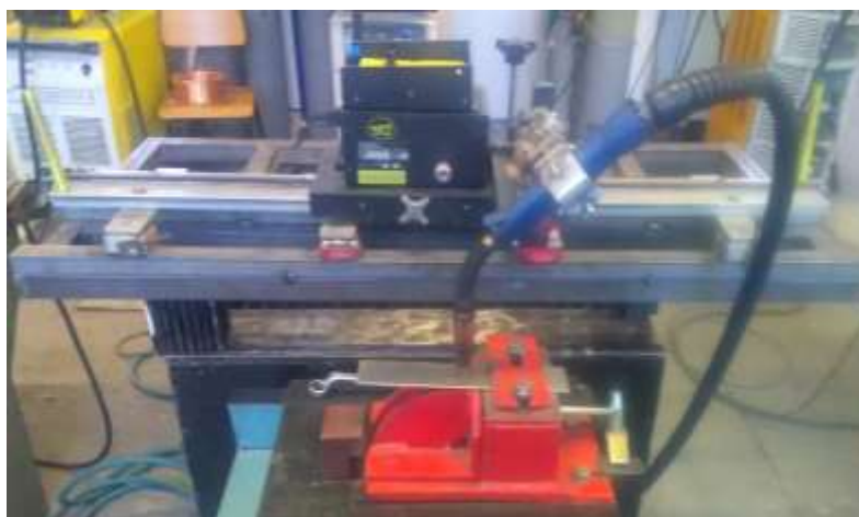
Slika 19. „Bug“ sustav za automatizaciju MIG/MAG zavarivanja
