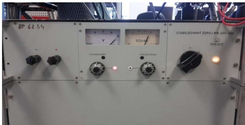
Slika 33. Uređaj za regulaciju napona i temperature u komori
