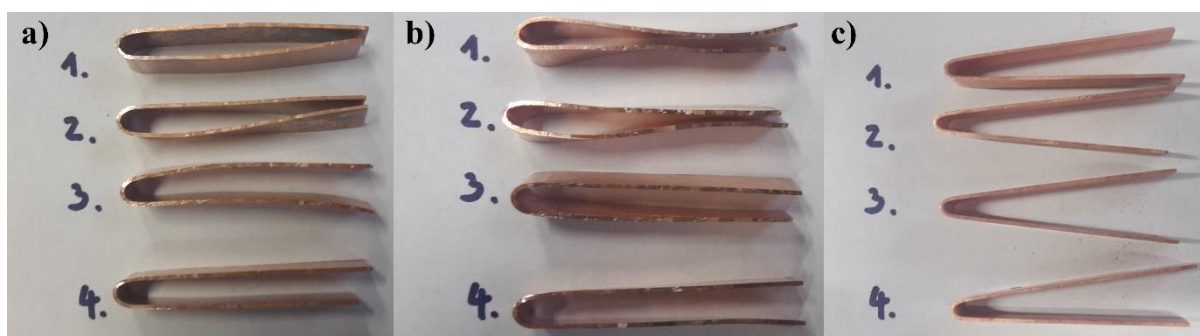
Slika 65. Uzorci nakon savijanja: a) Cu + grafen (očišćeni) b) Cu + grafen (neočišćen) c) Cu
