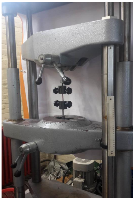
Slika 53. Univerzalna kidalica za statičko vlačno ispitivanje
