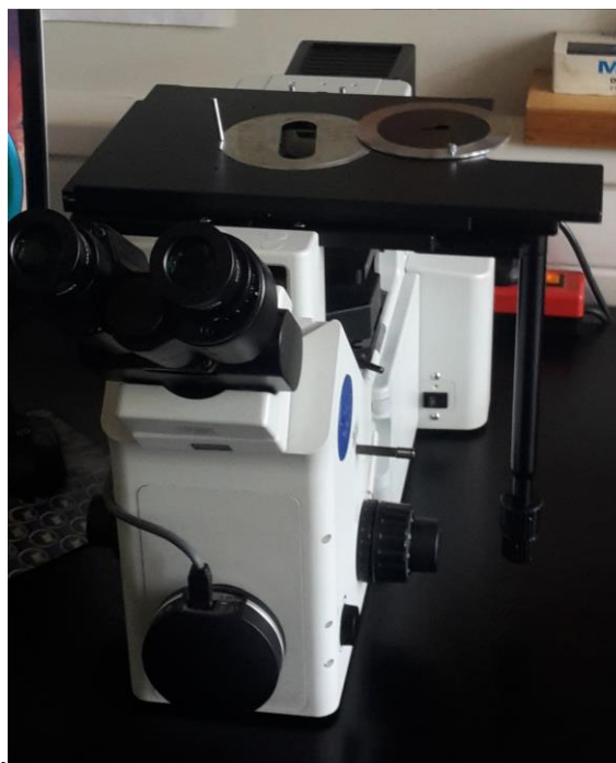
Slika 48. Svjetlosni mikroskop za metalografsku analizu
