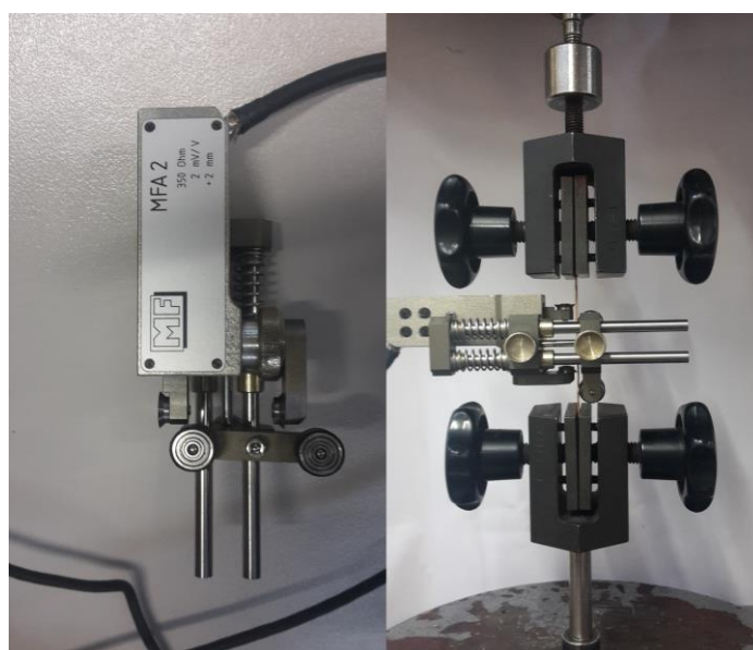
Slika 55. Ekstenziometar za mjerenje produljenja epruvete
