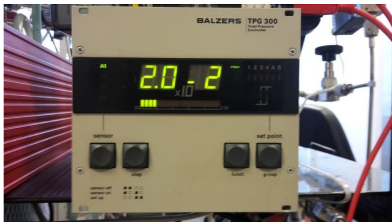
Slika 31. Uređaj za praćenje tlaka u komori
