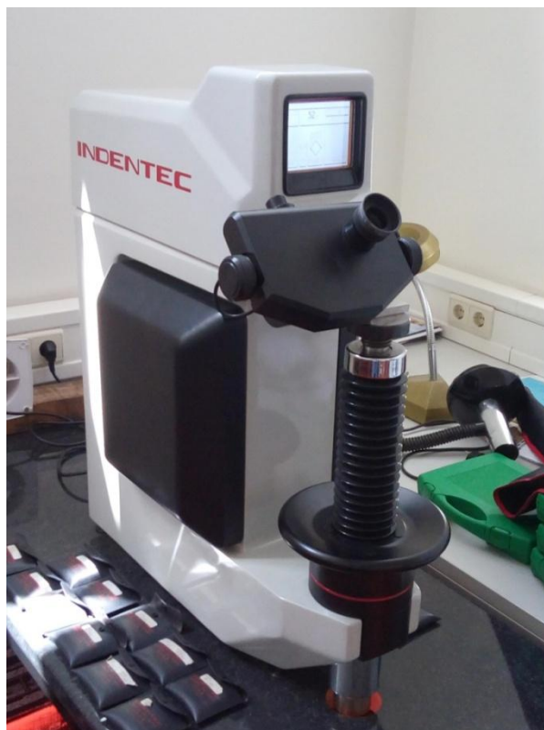
Slika 68. Referentni tvrdomjer „Indentec“
