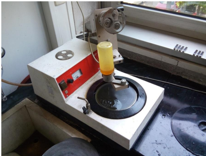
Slika 31. Uređaj za poliranje „Struers DAP-V“
