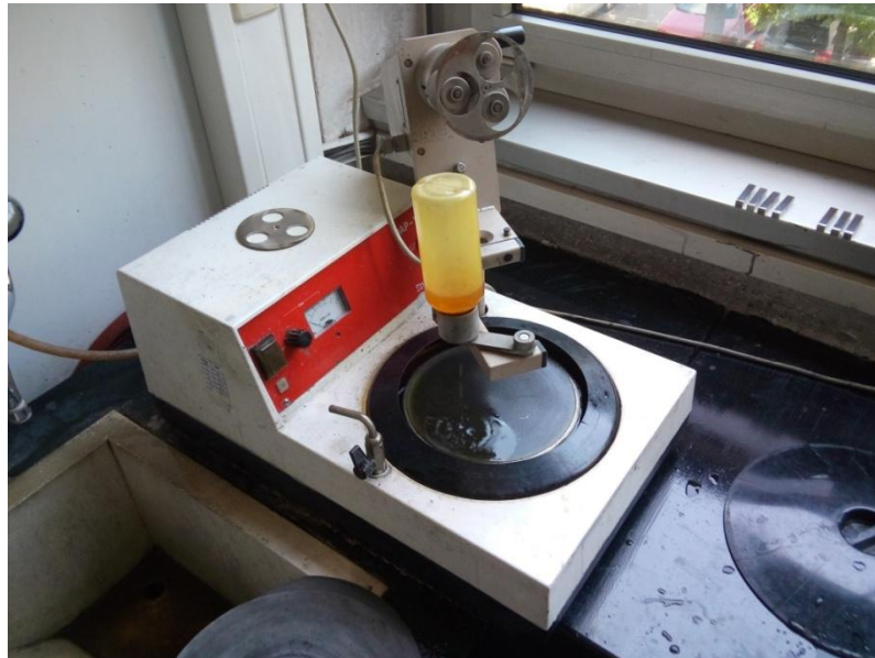
Slika 31. Uređaj za poliranje „Struers DAP-V“
