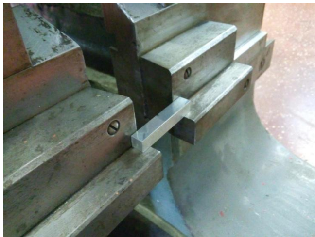
Slika 58. Položaj epruvete u osloncima
