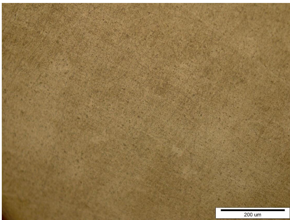
Slika 54. Mikrostruktura uzorka 25/ dozrijevano 10 h pri 190 °C
