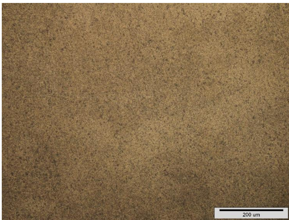
Slika 52. Mikrostruktura uzorka 22/ dozrijevano 4 h pri 190 °C
