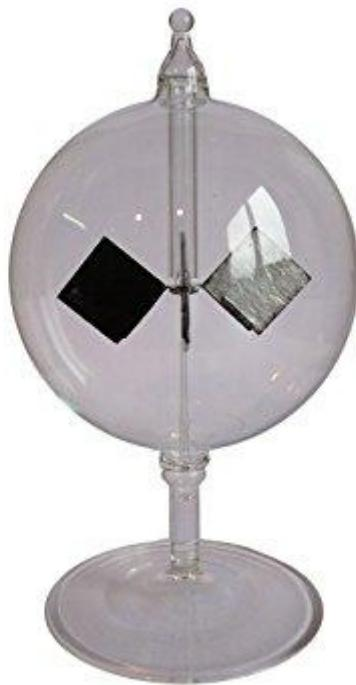
**Slika 9 – Radiometar s dvije sfere**
