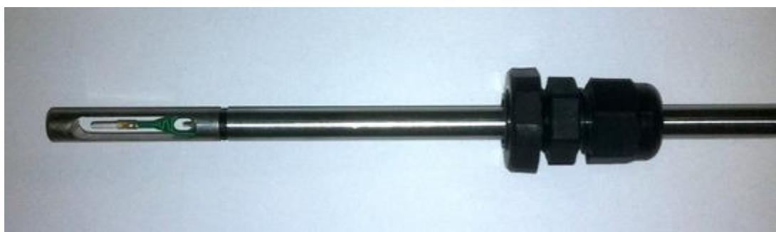
Slika 33 – Anemometar sa žarnom niti
