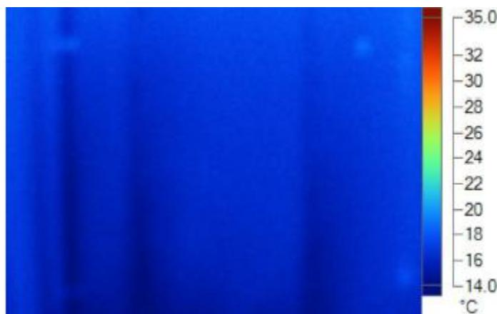
**Slika 55 - Temperaturni profil zida u slučaju grijanja prostorije radijatorom (dio zida smještenog lijevo od ulaznih vrata)**
