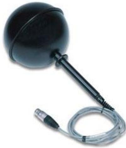
**Slika 8 – Termometar s crnom sferom**
