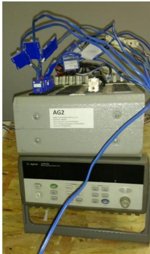
Slika 31 – Analogno-digitalni pretvarač signala
