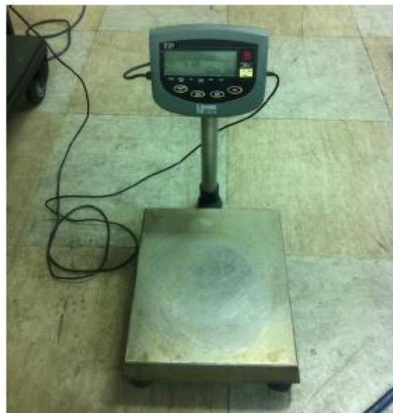
**Slika 35 – Vaga za kontrolu točnosti izmјerenog protoka**
