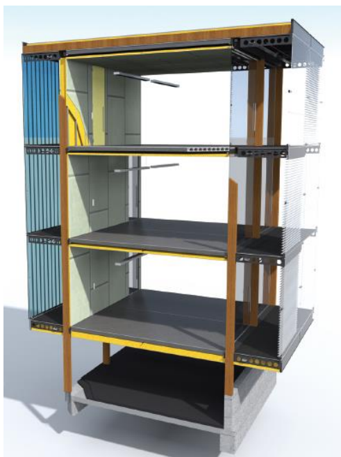
Slika 54 Presjek konačne varijante
