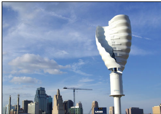
Slika 6.1. Helix Wind vjetroturbina
