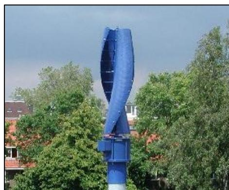
Slika 3.11. Spiralna Savoniusova vjetroturbina
