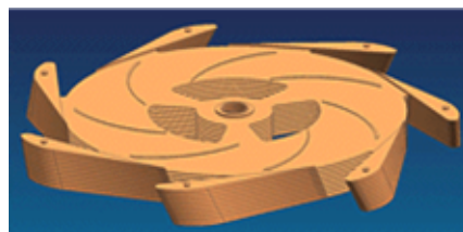
Slika 6.7. Prikaz slaganja diskova unutar Tesnic vjetroturbine
