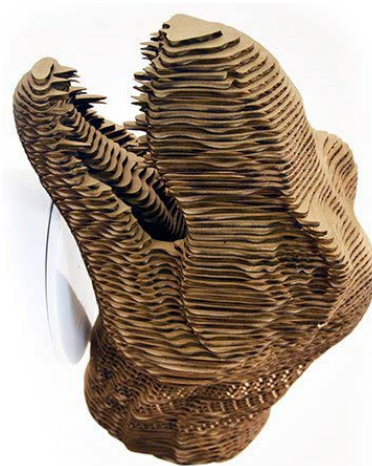
Slika 1 Princip dodavanja slojeva materijala kod aditivnih postupaka proizvodnje [6]
