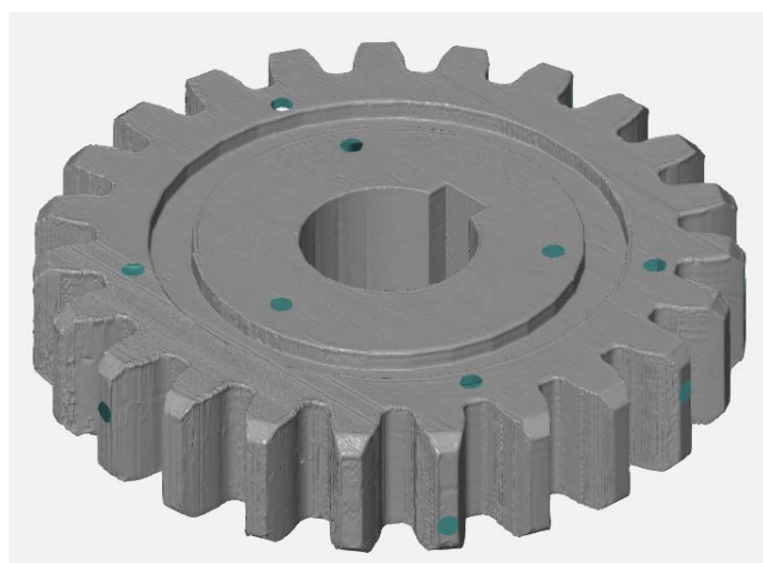
Slika 30 Poligonizirani zupčanik Z1.1
