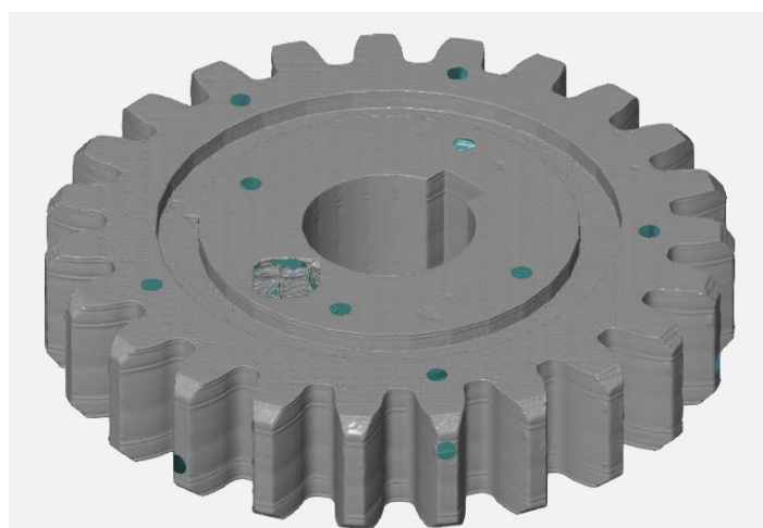
Slika 31 Poligonizirani zupčanik Z1.2
