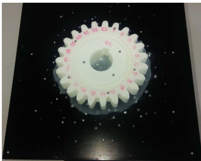
Slika 23 Zupčanic 1.2 sa slojem titanovog oksida
