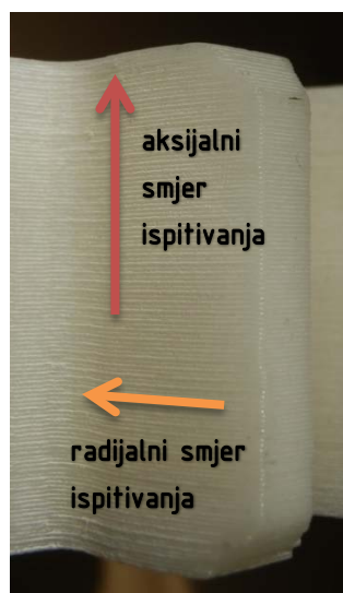
Slika 17 Smjerovi ispitivanja hrapavosti
