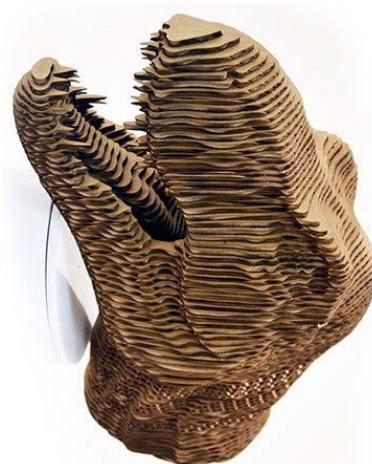
Slika 1 Princip dodavanja slojeva materijala kod aditivnih postupaka proizvodnje [6]
