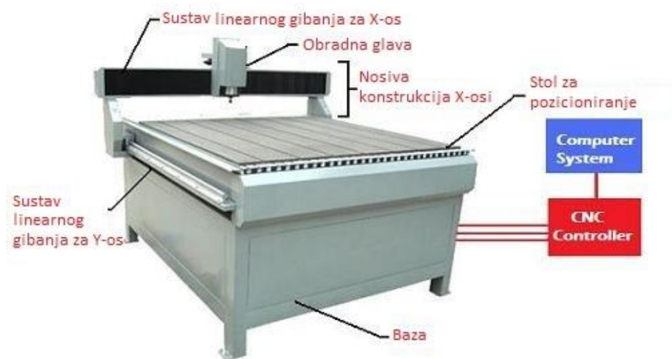
Slika 10 Glavne komponente CNC glodalice
