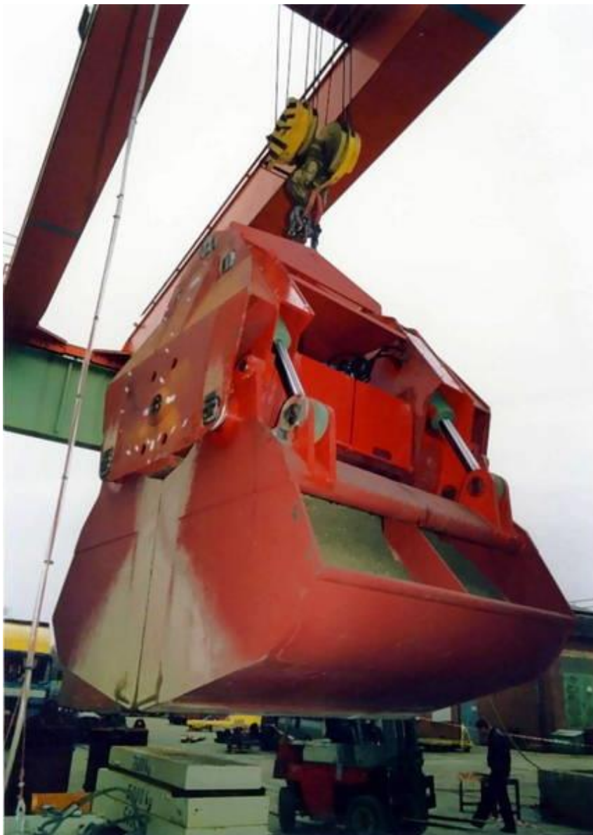
Slika 3. Hidraulična trim grabilica [4]
