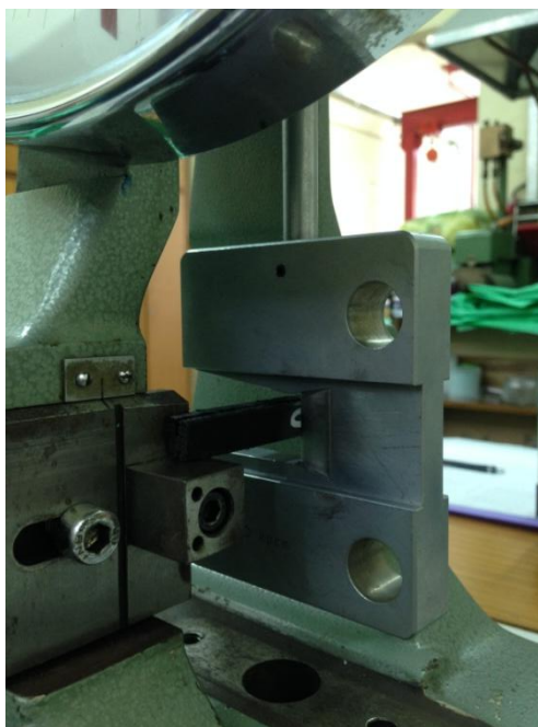
Slika 45. Epruveta postavljena na oslonac stroja
