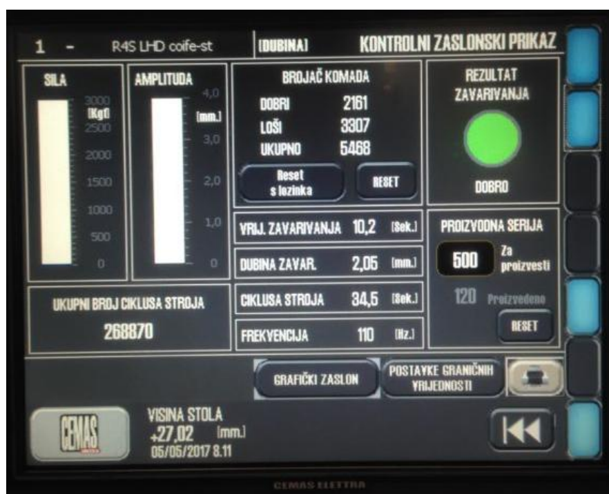
Slika 39. Parametri vibracijskog zavarivanja
