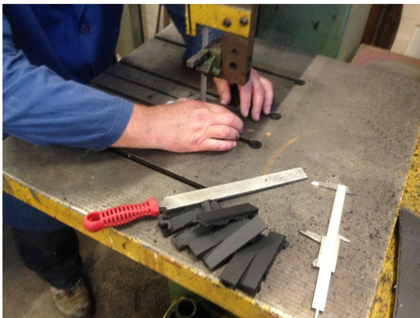
Slika 41. Fino rezanje i brušenje epruveta
