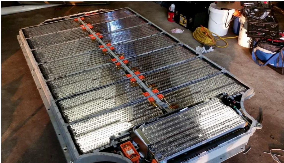
Slika 37. Moduli u Teslinom baterijskom paketu
