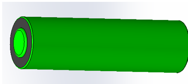
Slika 43. CAD model cilindrične ćelije 21700
