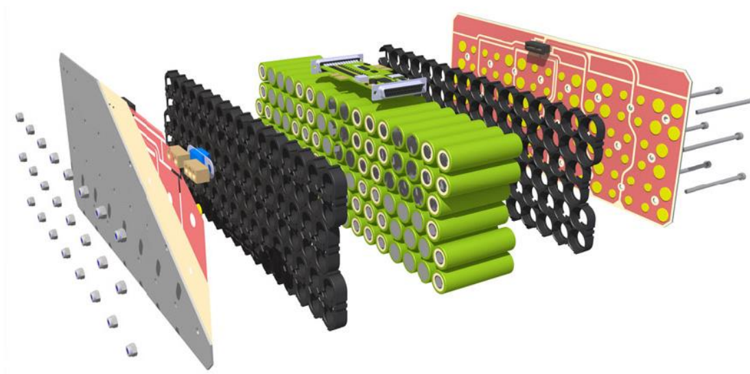
Slika 39. Ekspandirani prikaz baterijskog modula sa svim njegovim elemenata
