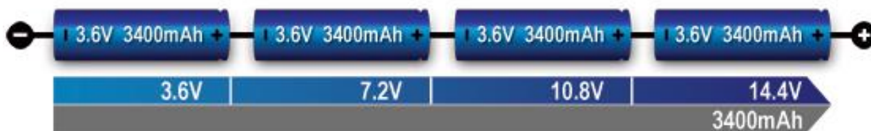
Slika 33. Serijski spoj baterijskih ćelija
