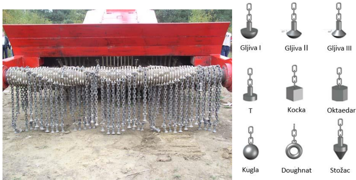
Slika 3. Alat s mlatilicama i različiti oblici mlatilica
