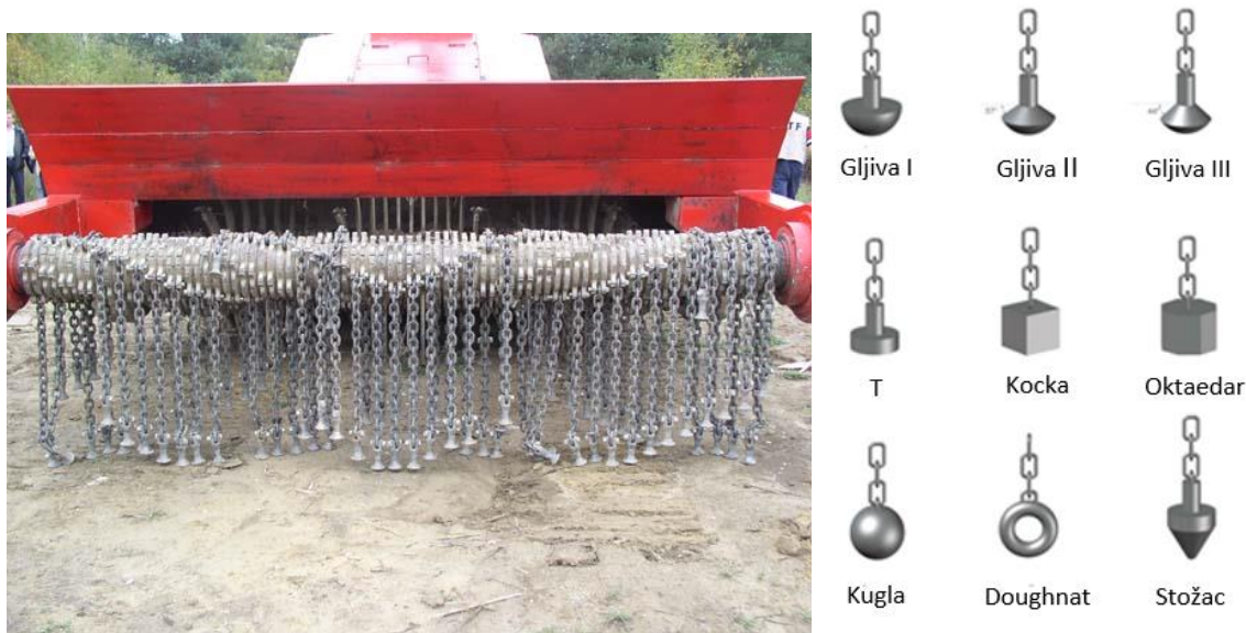
Slika 3. Alat s mlatilicama i različiti oblici mlatilica
