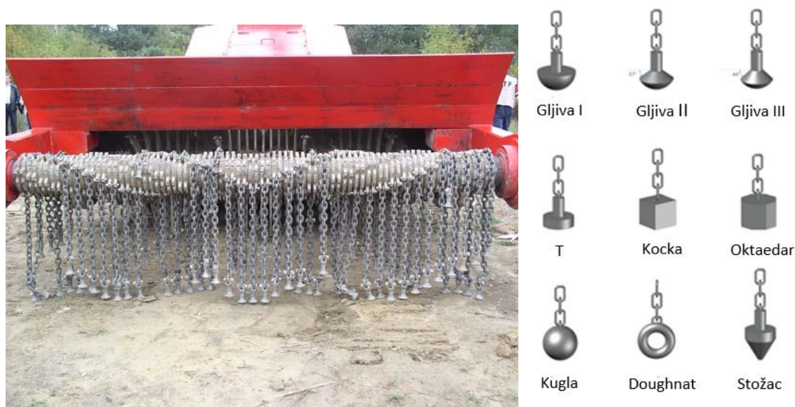
Slika 3. Alat s mlatilicama i različiti oblici mlatilica
