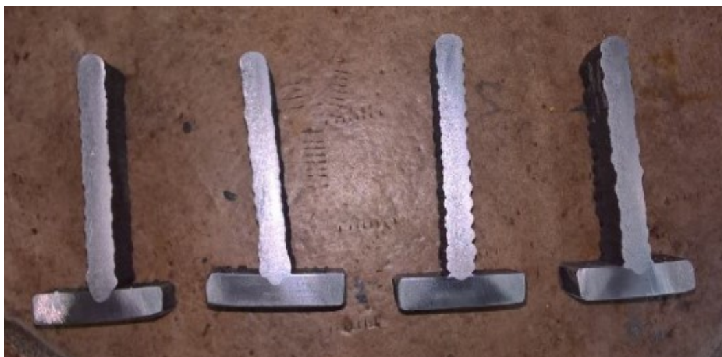
Slika 55. Uzorci nakon nagrizanja
