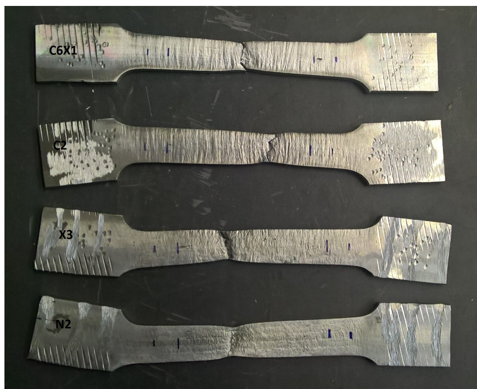
Slika 72. Epruvete nakon ispitivanja
