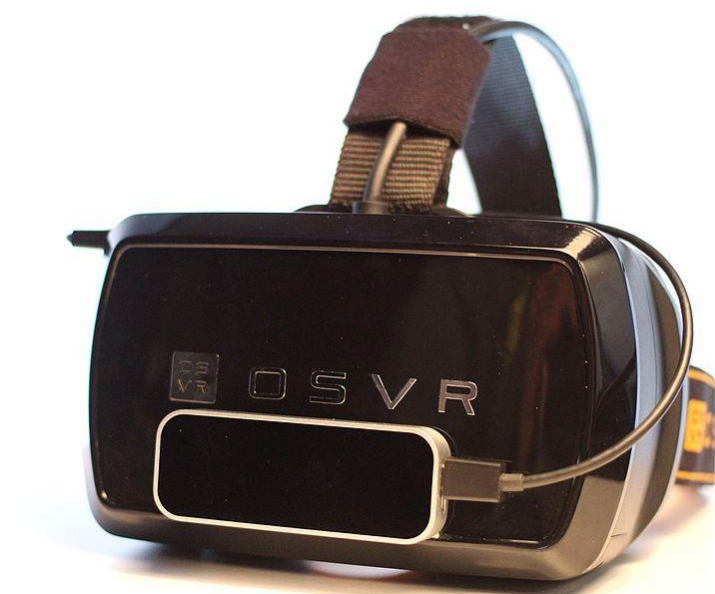
Slika 39. Kontroler Leap Motion montiran na OSVR headset [34]
