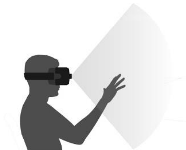
Slika 43. Ilustracija radnog pojasa kontrolera Leap Motion [38]
