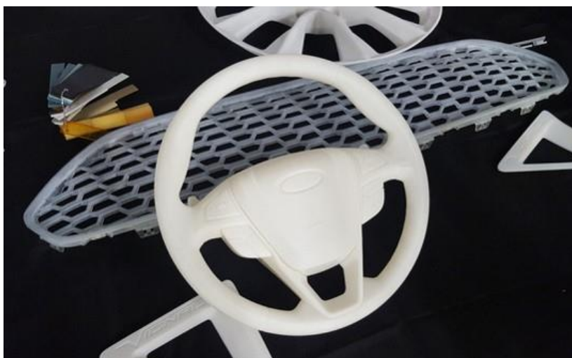
Slika 20 Provjera ergonomije upravljača prije izrade
