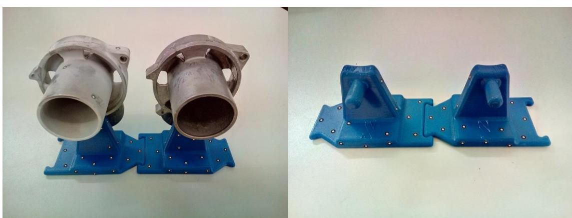
Slika 60 Primjer držača objekta pripremljenog za 3D skeniranje
