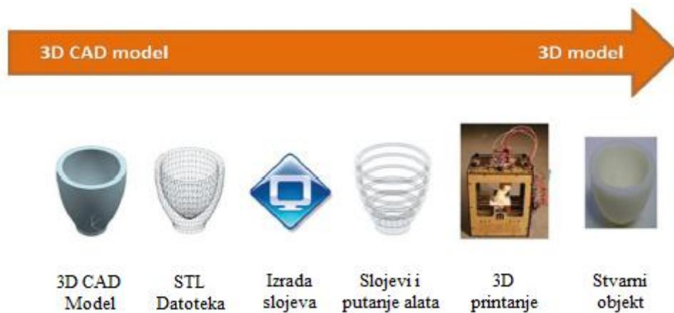
**Slika 19 Faze u procesu brze izrade prototipova**
