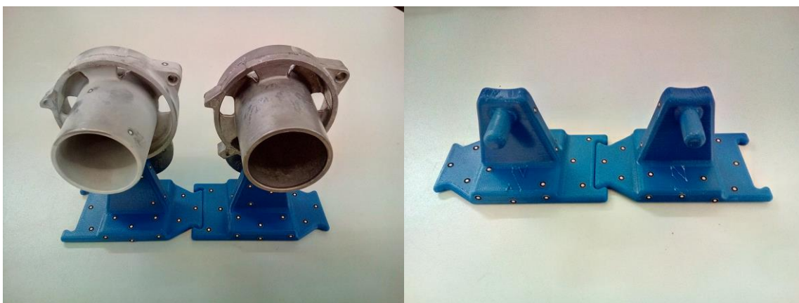
Slika 60 Primjer držaća objekta pripremljenog za 3D skeniranje
