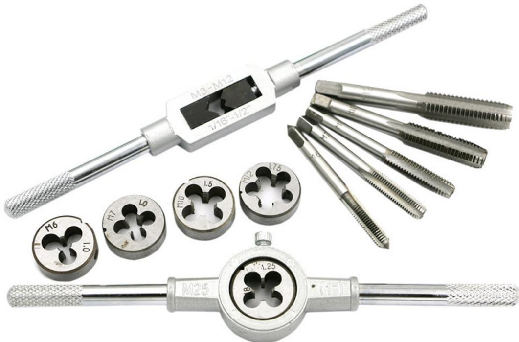
Slika 7. Set za ručno urezivanje i narezivanje navoja [8]
