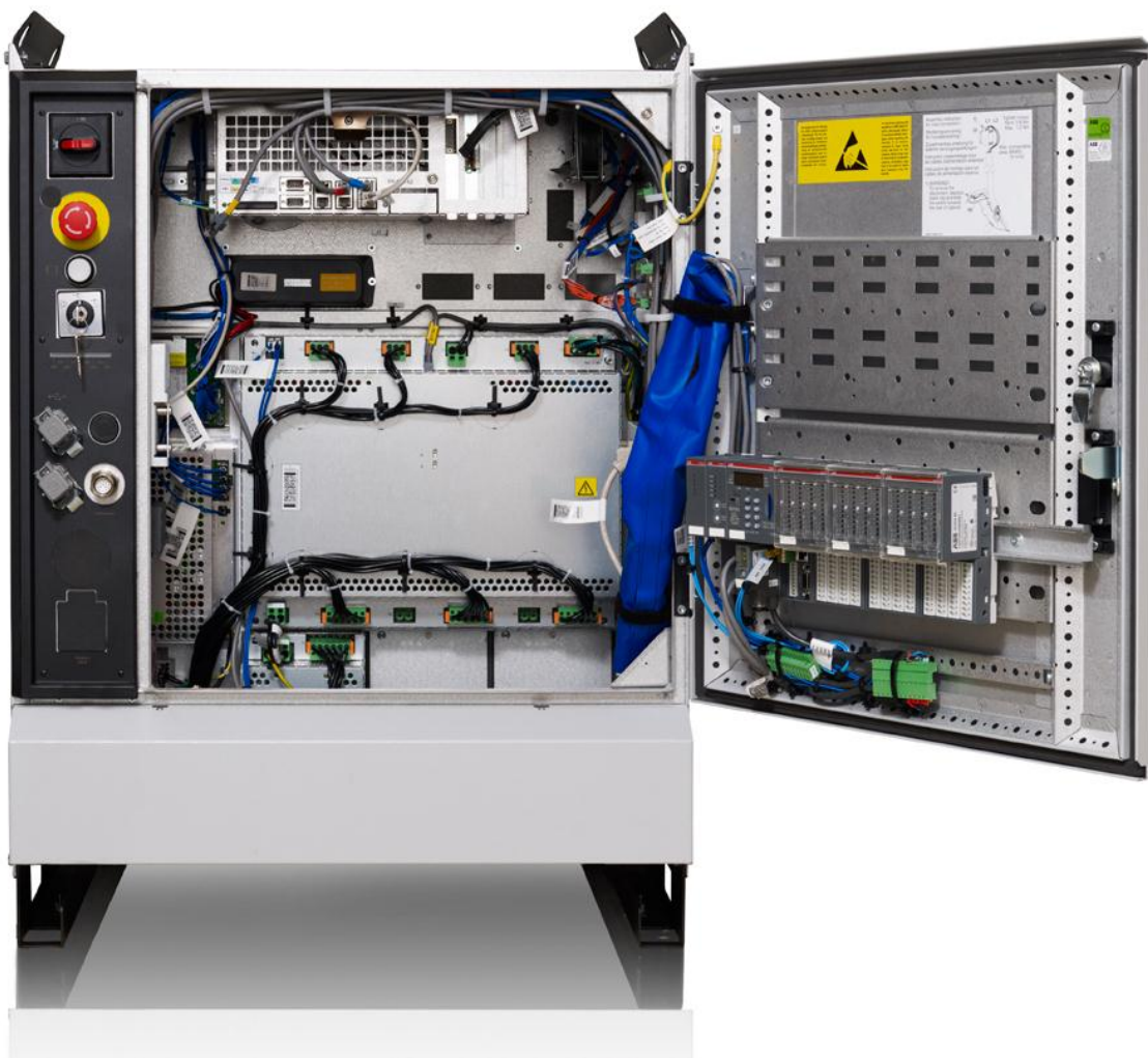
Slika 61. Upravljački ormar IRC5
