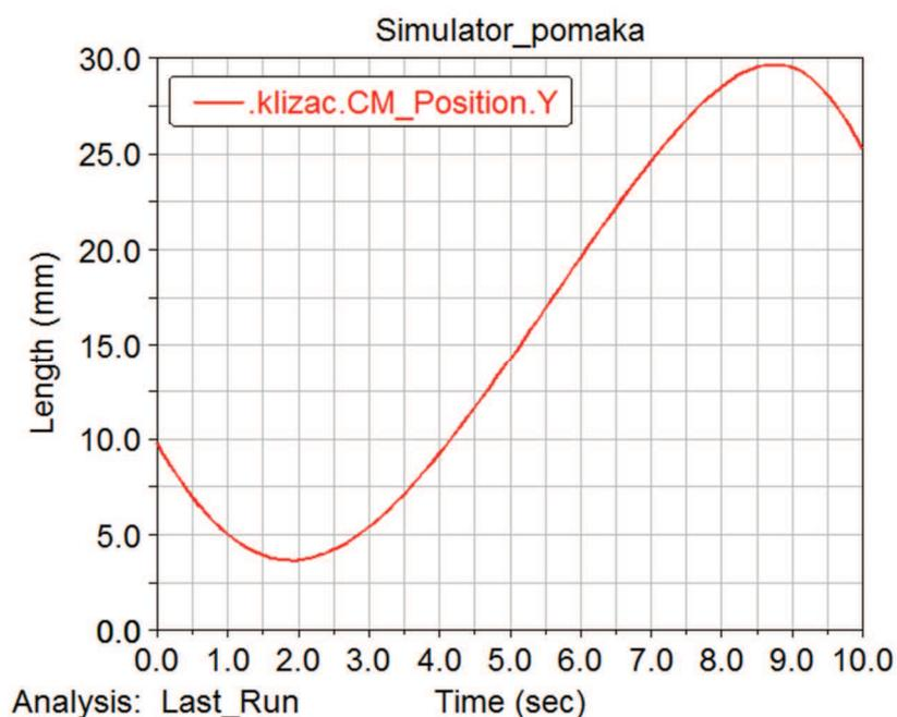
Slika 34. Simulacija vertikalnog pomaka lijevog kraja dulje poluge
