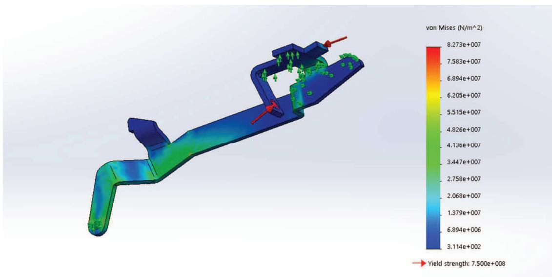
Slika 47. Prikaz rezultata statičke analize – prikaz napraznanja
