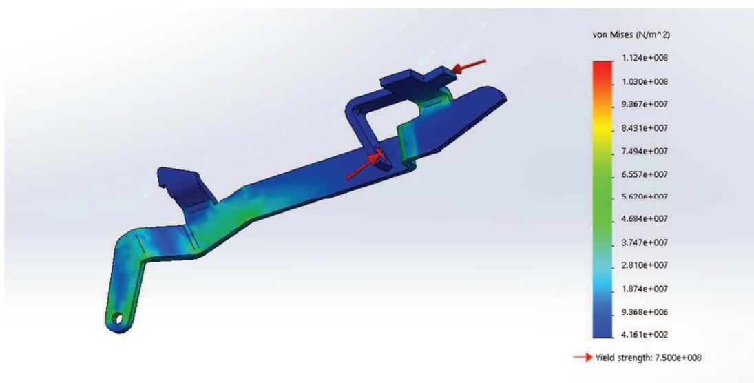
Slika 53. Prikaz rezultata statičke analize – prikaz napraznanja
