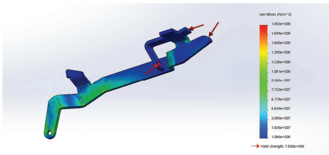
Slika 56. Prikaz rezultata statičke analize – prikaz naprezanja
