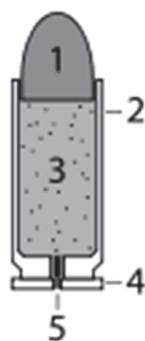
1. projektil (zrno, kugla; ujedno i kalibar metka)
