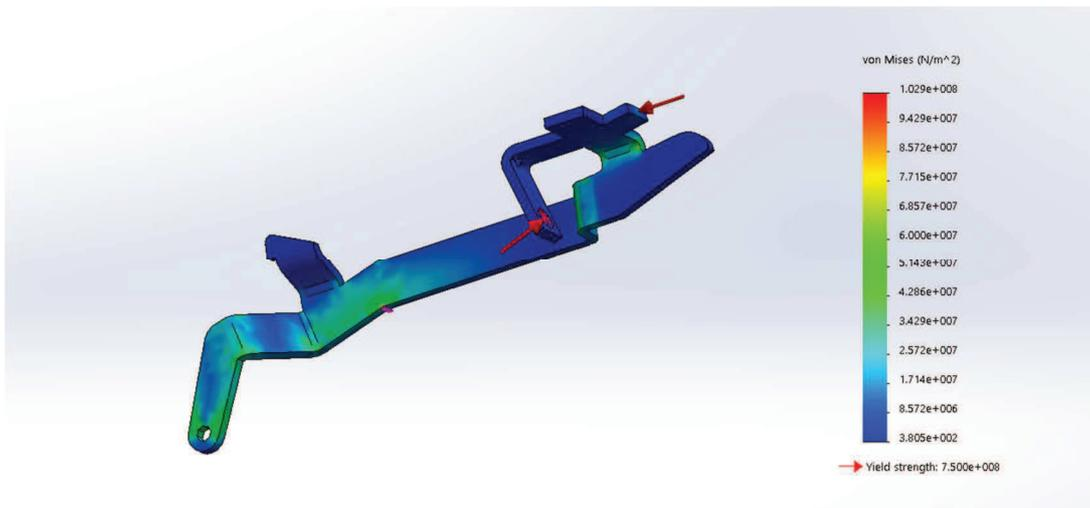
Slika 49. Prikaz rezultata statičke analize – prikaz napraznanja
