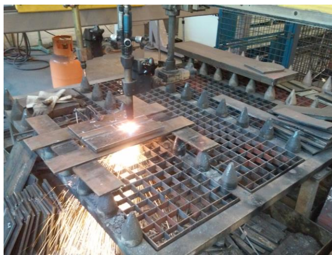
Slika 49. Plinsko rezanje traka
