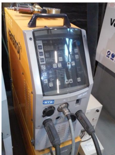
Slika 32. Izvor struje za zavarivanje MIG/MAG VPS 4000 digit
