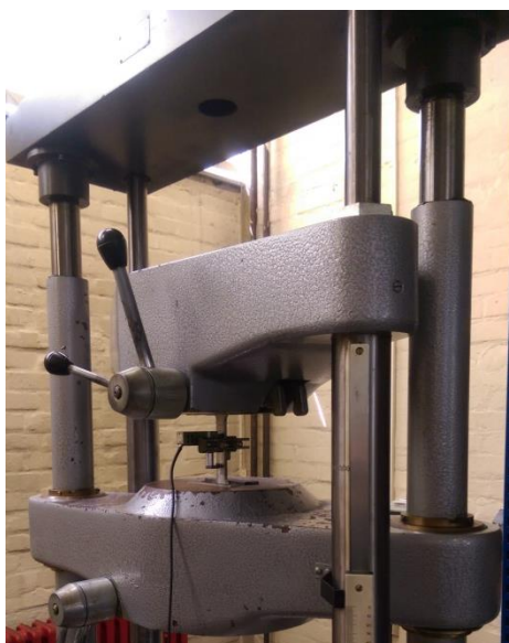
Slika 28. Kidalica i uzorak postavljen za testiranje
