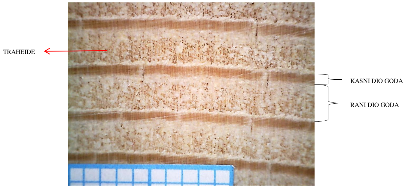
Slika 4.13. Makrostruktura poprečnog presjeka jele
