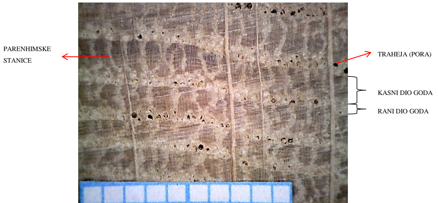
Slika 4.6. Makrostruktura poprečnog presjeka hrasta
