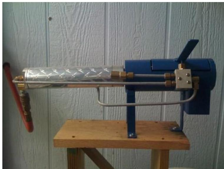
**Slika 8. Pneumatska preša EZ Power Crusher**
