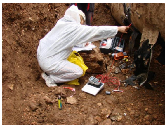
Slika 15. Izravno mjerenje potencijala cjevovod – tlo u iskopu [19]
