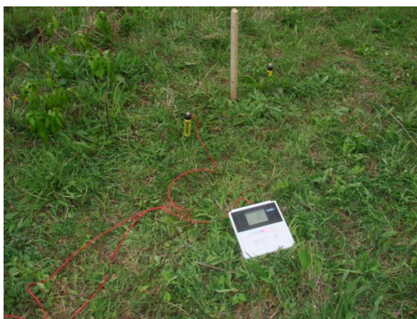
Slika 16. Neizravno ispitivanje – mjerenje gradijenta potencijala na površini [19]
