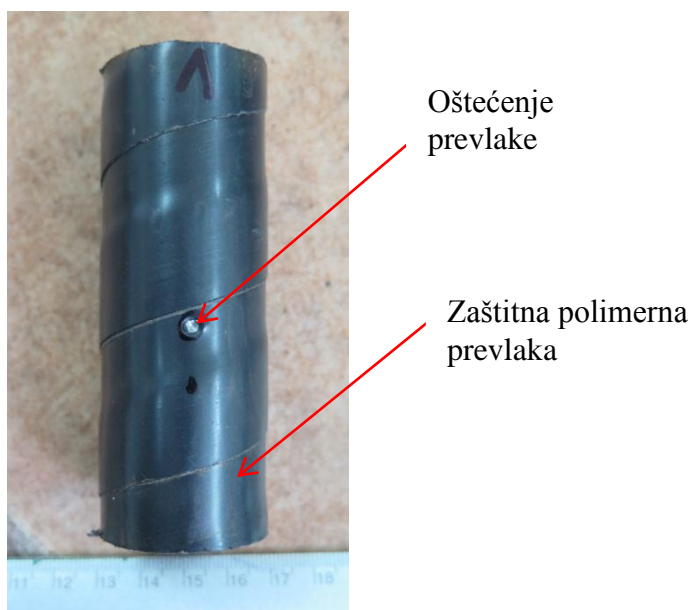
Slika 26. Prikaz uzorka s izvedenim oštećenjem prevlake
