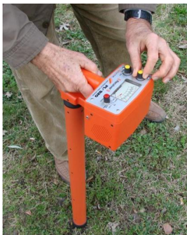
Slika 17. Lociranje cjevovoda tragačem (lokatorom) [19]
