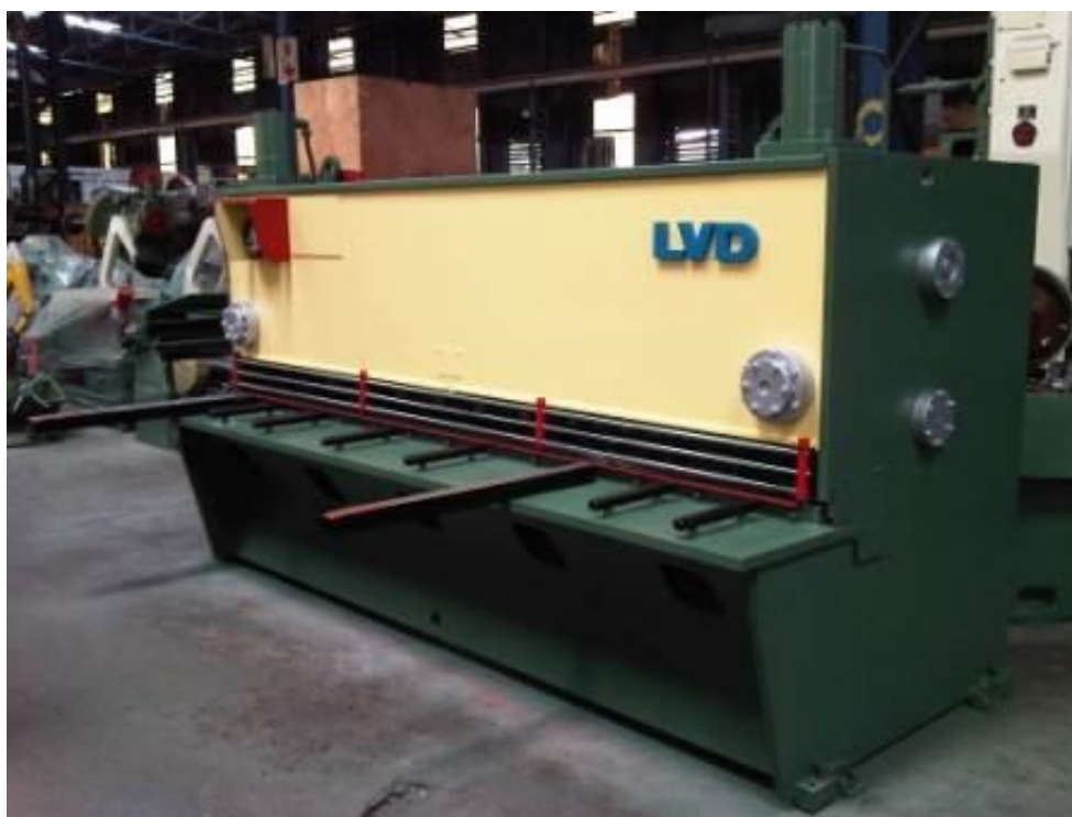
Slika. 18. Hidraulične škare MG 20/2 [12.]
