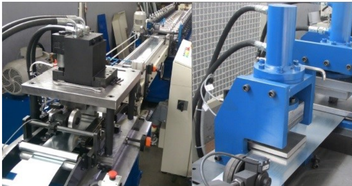
Slika. 25. Hidraulična preša za štancanje [13.]
