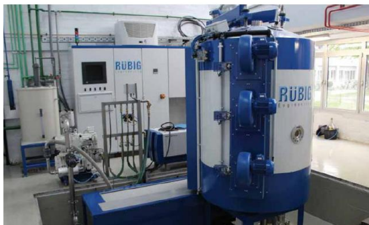
Slika 10. Uređaj RÜBIG PC 70/90 instaliran na FSB-u, [12]
