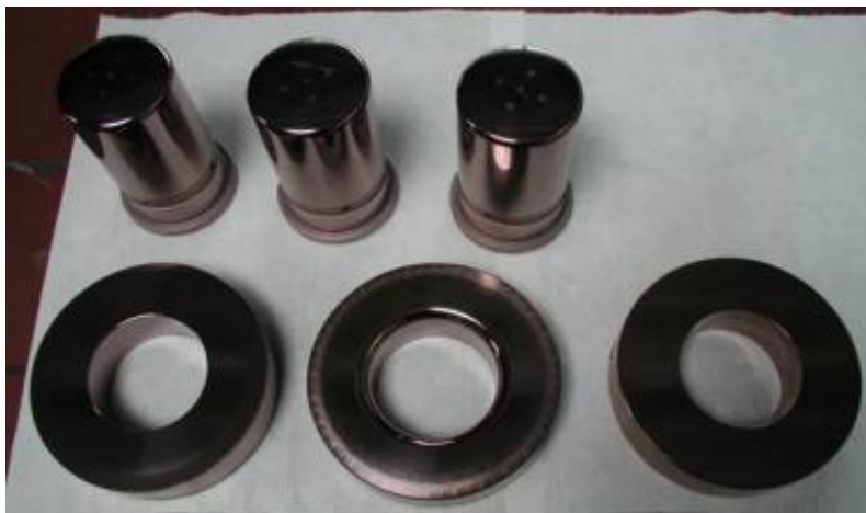
Slika 16. Dijelovi prevučeni TiN/TiCN prevlakom, [7]
