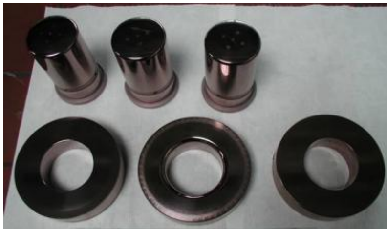
Slika 16. Dijelovi prevučeni TiN/TiCN prevlakom, [7]
