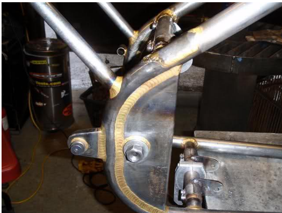
Slika 1: Primjer zavarivačkog lemljenja okvira motocikla [4]
