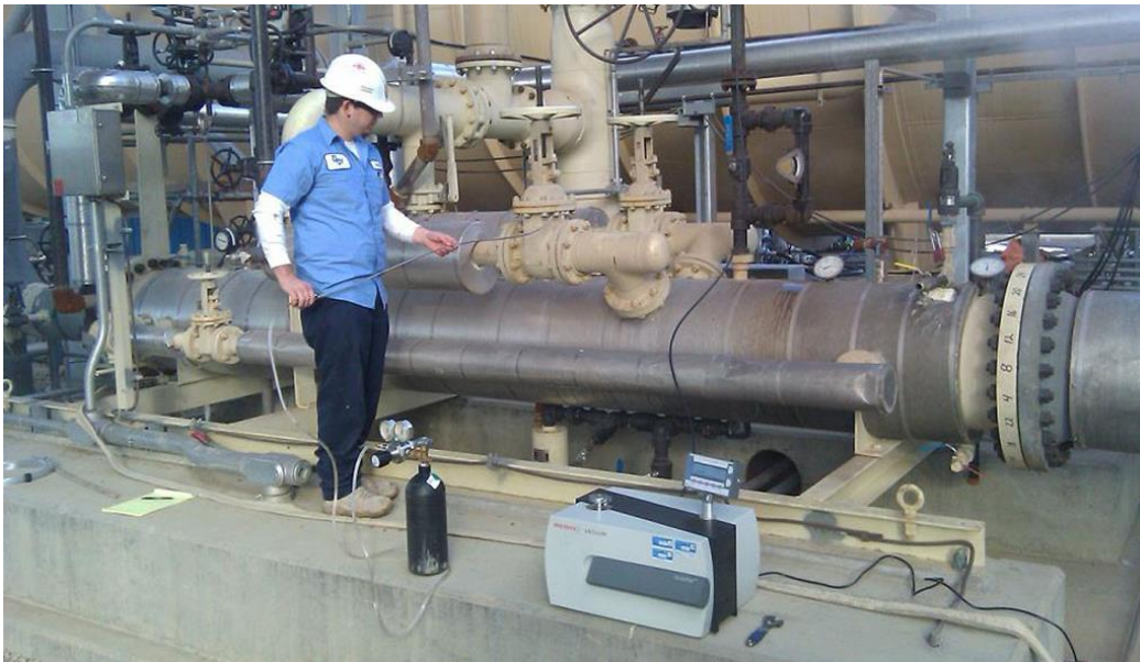
Slika 27: Ispitivanje istjecanja helijem [23]
