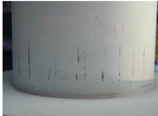
Slika 26: Indikacija pukotina prikazana obojenim penetrantom [20]
