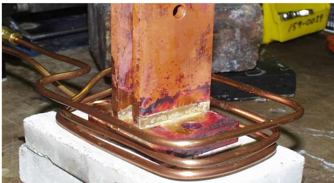
Slika 7: Sklop unutar induktora nakon lemljenja [11]
