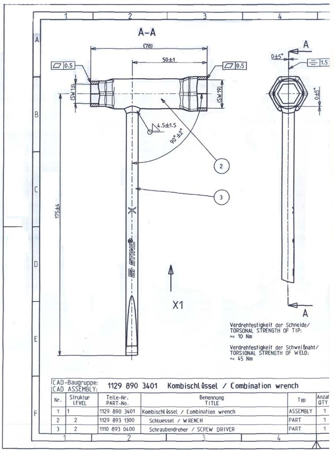
Sl. 23. Nacrt kombiniranog ključa s tolerancijskim zahtjevima
