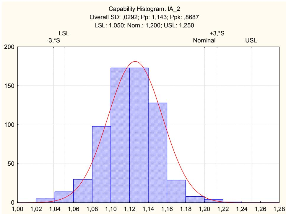
Sl. 89. Histogram mjernih podataka, 2. izmjena alata
