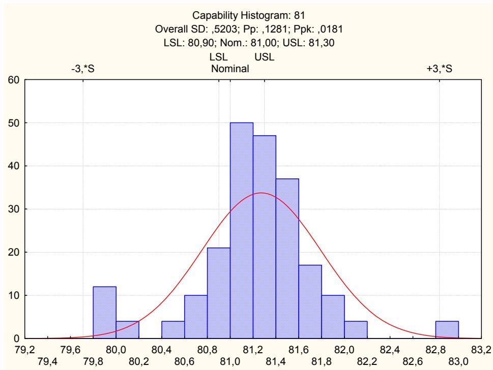
Sl. 81. Histogram izmjerjenih dužina cijevi, Selectomat 6714, 81 mm
