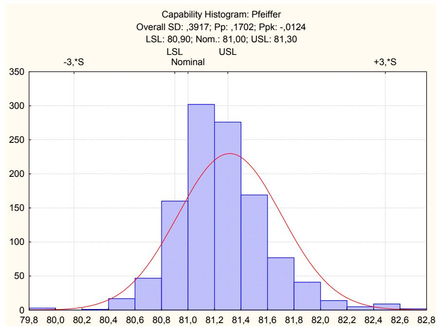
Sl. 83. Histogram izmjerjenih dužina cijevi, Pfeiffer, 81 mm
