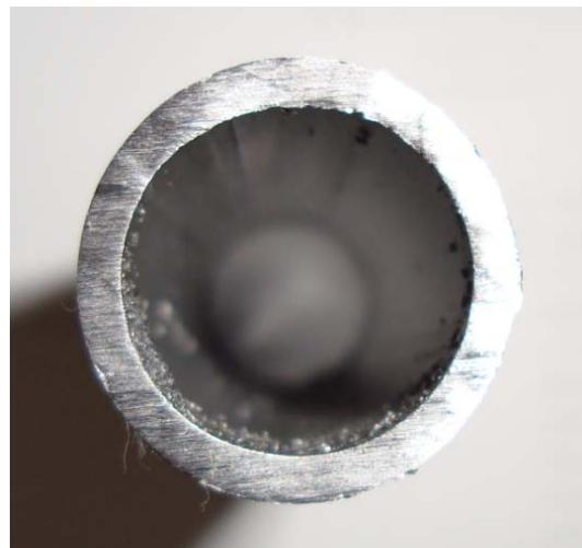
Sl. 9. Izgled cijevi odrezane na stroju HAP 280
