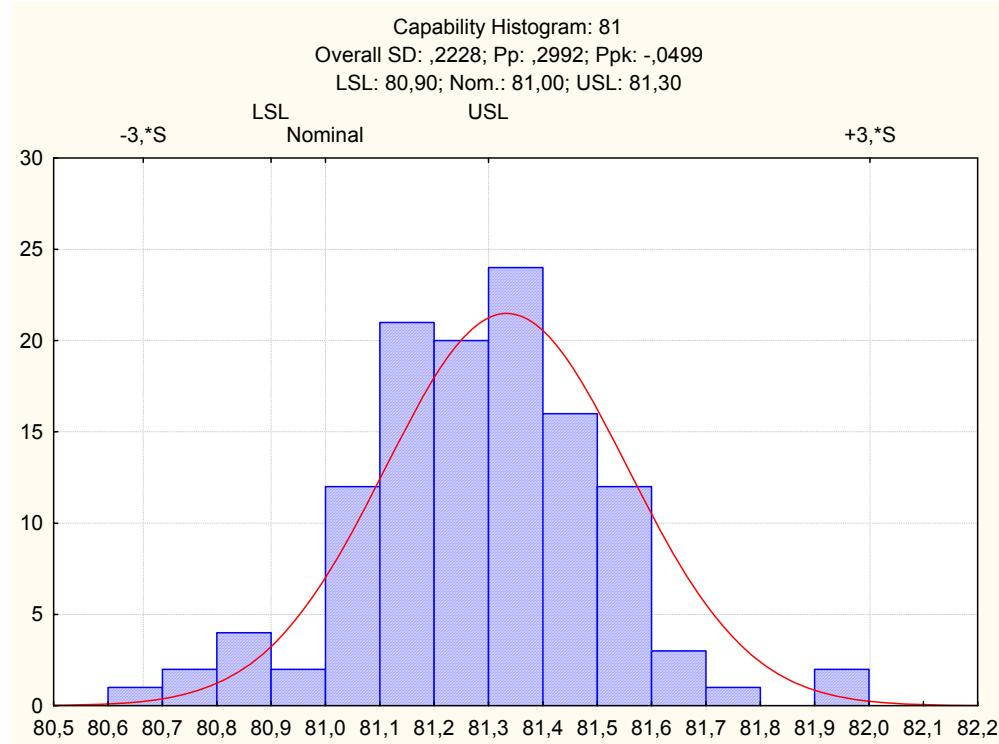
Sl. 79. Histogram izmjerjenih dužina cijevi, Selectomat 6609, 81 mm
