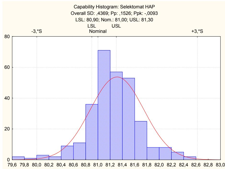
Sl. 77. Histogram izmjerjenih dužina cijevi, Selectomat HAP, 81 mm
