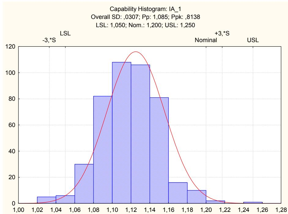
Sl. 87. Histogram mjernih podataka, 1. izmjena alata
