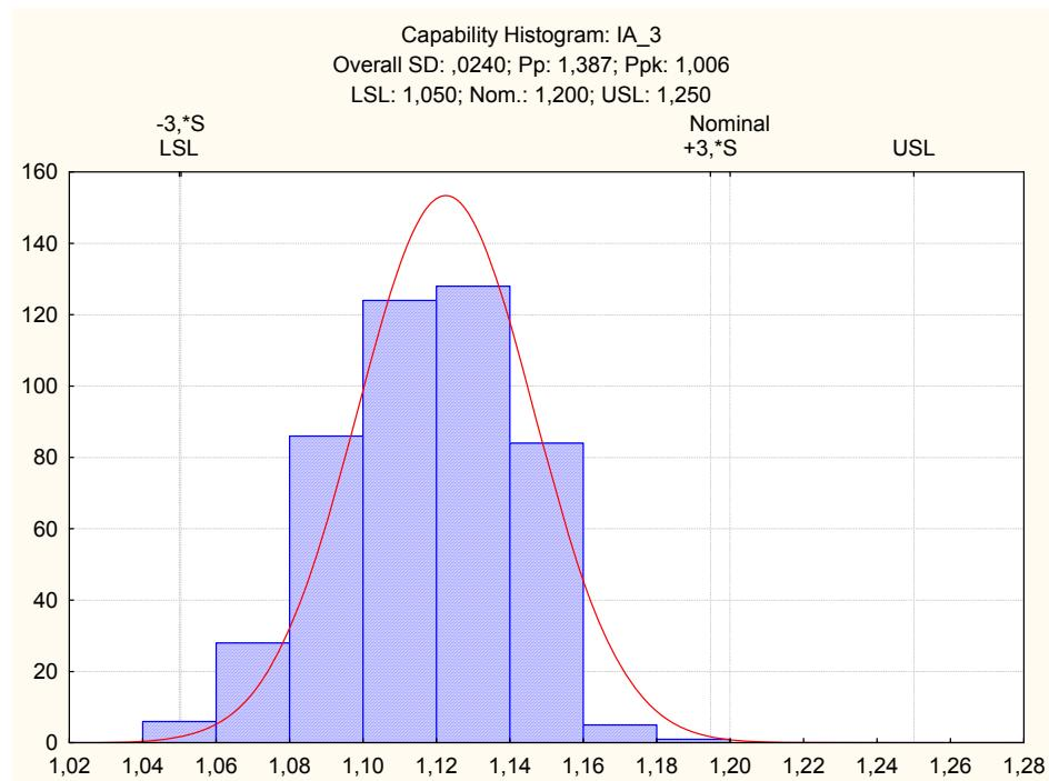
Sl. 91. Histogram mjernih podataka, 3. izmjena alata
