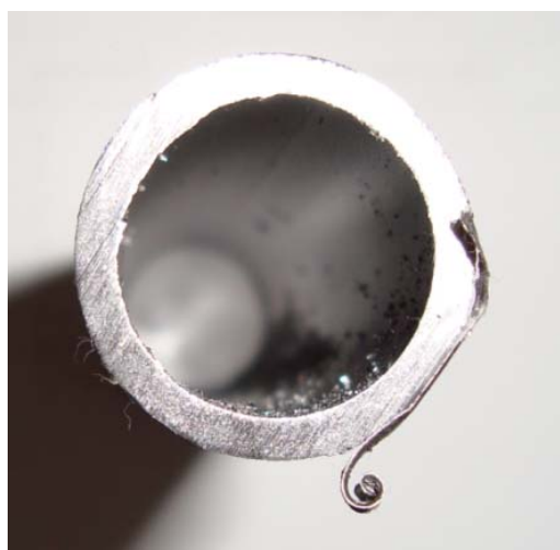
Sl. 10. Izgled cijevi odrezane na stroju Selectomat 320 S
