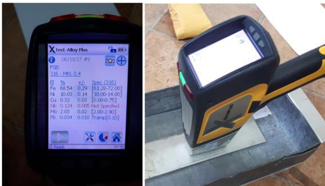
Slika 37: Ispitivanje kemijskog sastava XRF metodom
