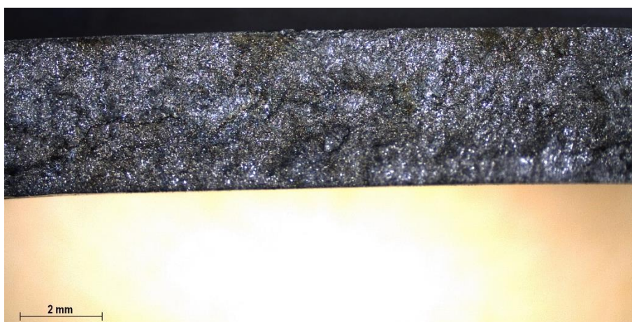
Uzorak AISI 316L zavaren i napregnut vijkom
