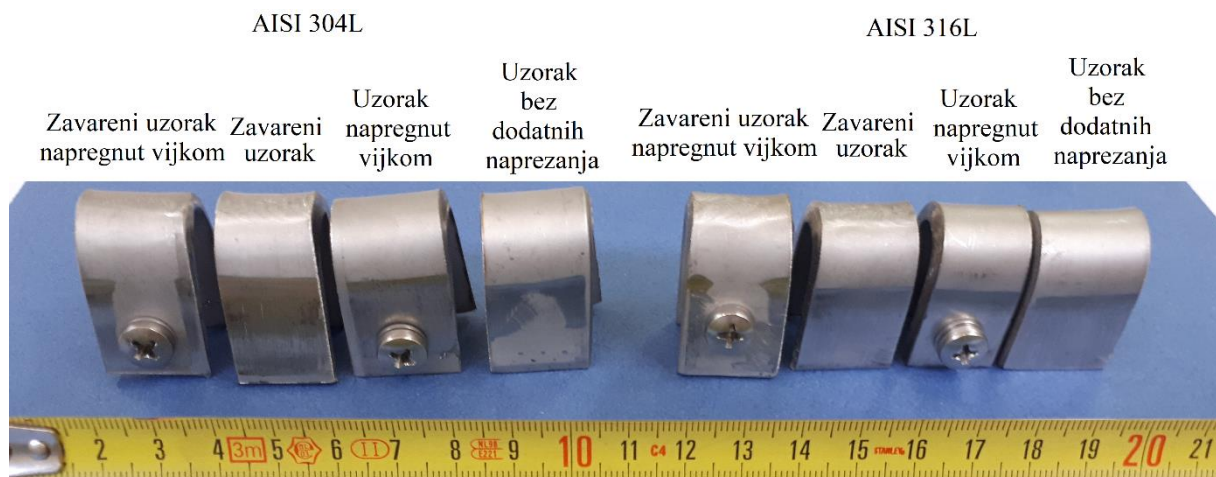
Slika 47: Skupina uzoraka za korozijsko ispitivanje
