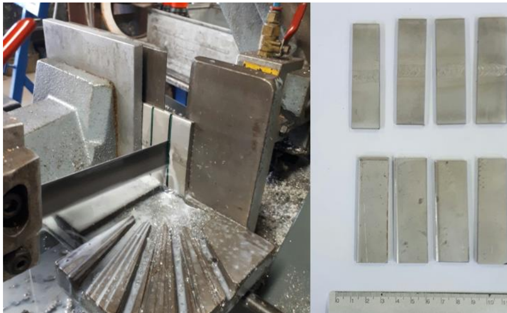
Slika 40: Ispitni uzorci (AISI 304L) tijekom i nakon izrezivanja na tračnoj pili
