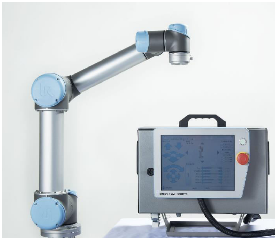
Slika 20. UR5 robot s upravljačkom jedinicom i privjeskom za učenje [10]
