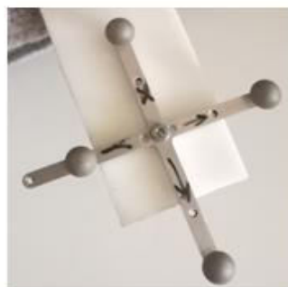
Slika 17. Korišteni alati s pasivnim retroreflektivnim markerima
