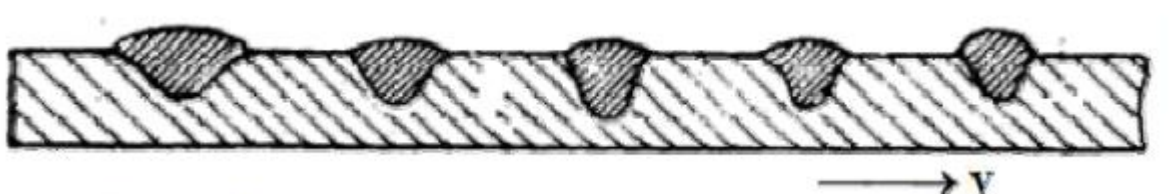
Slika 5. Utjecaj brzine zavarivanja na oblik zavora [7]
