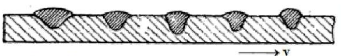
Slika 5. Utjecaj brzine zavarivanja na oblik zavora [7]
