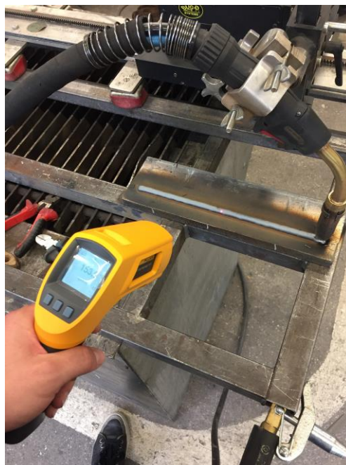
Slika 37. Mjerenje temperature međuprolaza [31]
