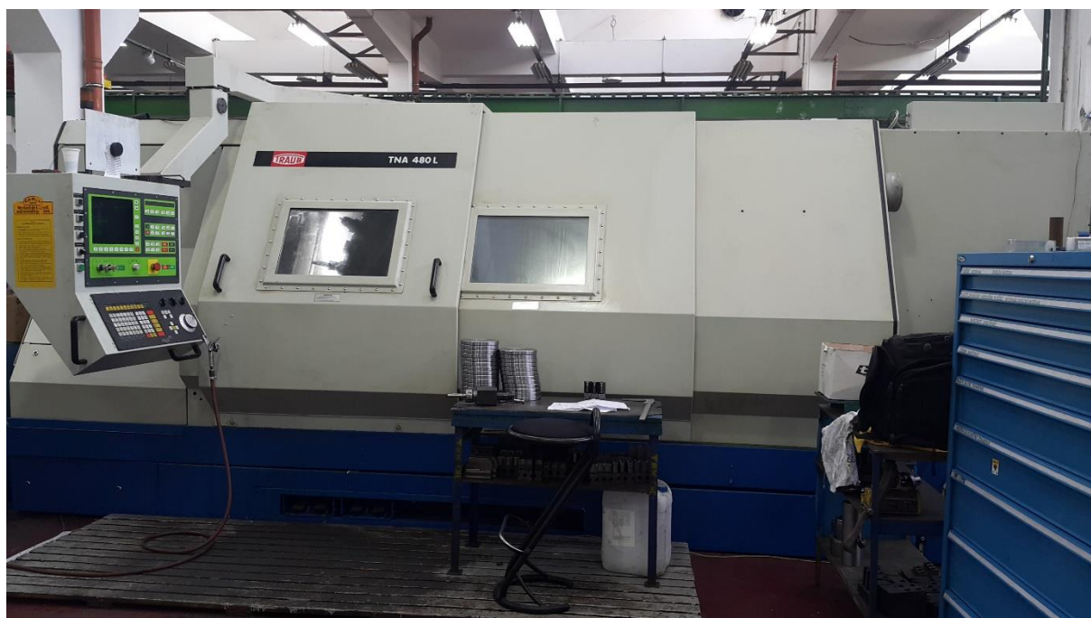
Slika 9.10. CNC tokarilica Traub TNA 480
