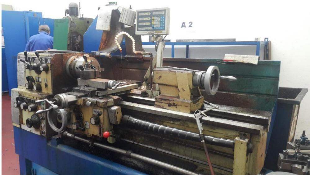
**Slika 9.15. Klasični tokarski stroj Alfa 410×1000**
