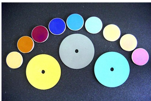
Slika 4.5. Različita obojenja titana nakon postupka anodne oksidacije [15]
