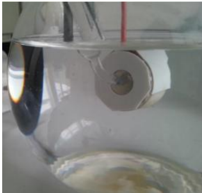
Slika 9.4. Radna elektroda uronjena u 0,9 % NaCl pri sobnoj temperaturi
