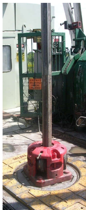
Slika 8 Sklop Kelly profila, Kelly glavine, glavne glavine u okretnom stolu
