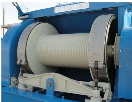
Slika 5 Sustav kočnica s uravnotežavajućom polugom
