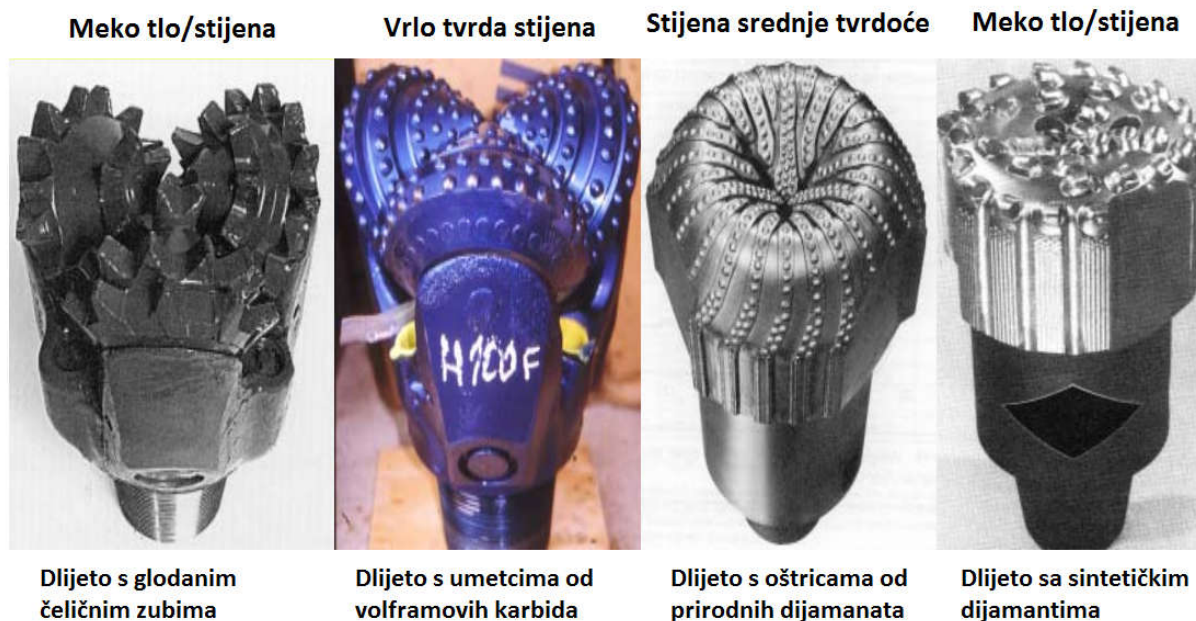
Slika 14 Dlijeta različitih konstrukcija ovisno o vrsti stijene koja se buši
