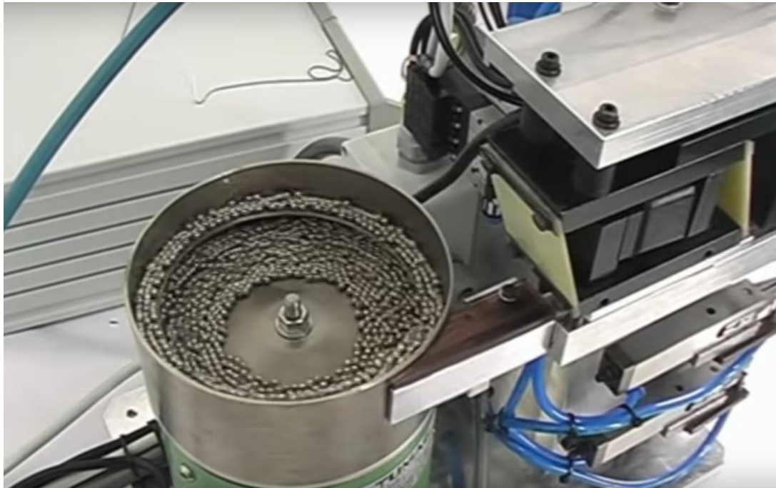
Slika 11. Dobava i usmjeravanje perli u Ciemmeov uređaj
