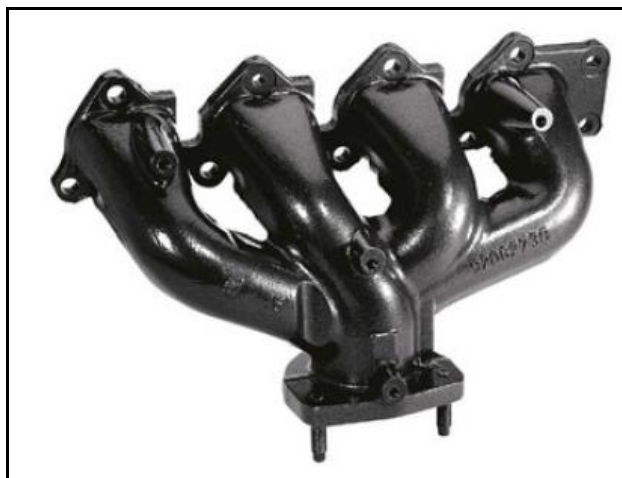
Slika 2.2 Ispušna grana izrađena od čeličnog lijeva [4]
