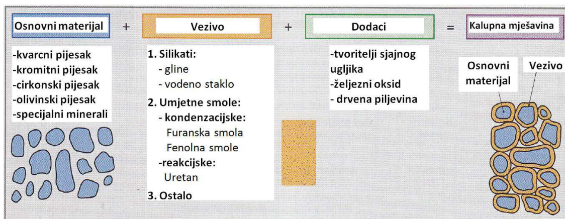
Slika 5. Sastav kalupne mješavine [6]
