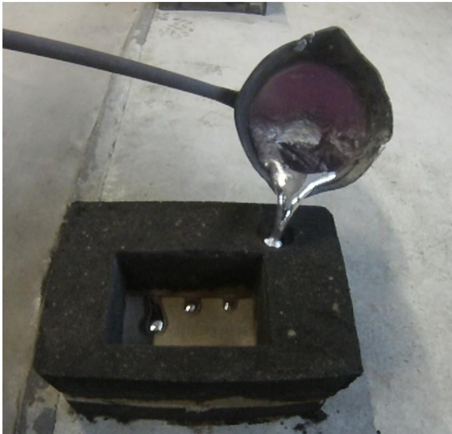
Slika 70. Lijevanje u sustav 1:2:2 1.3ds
