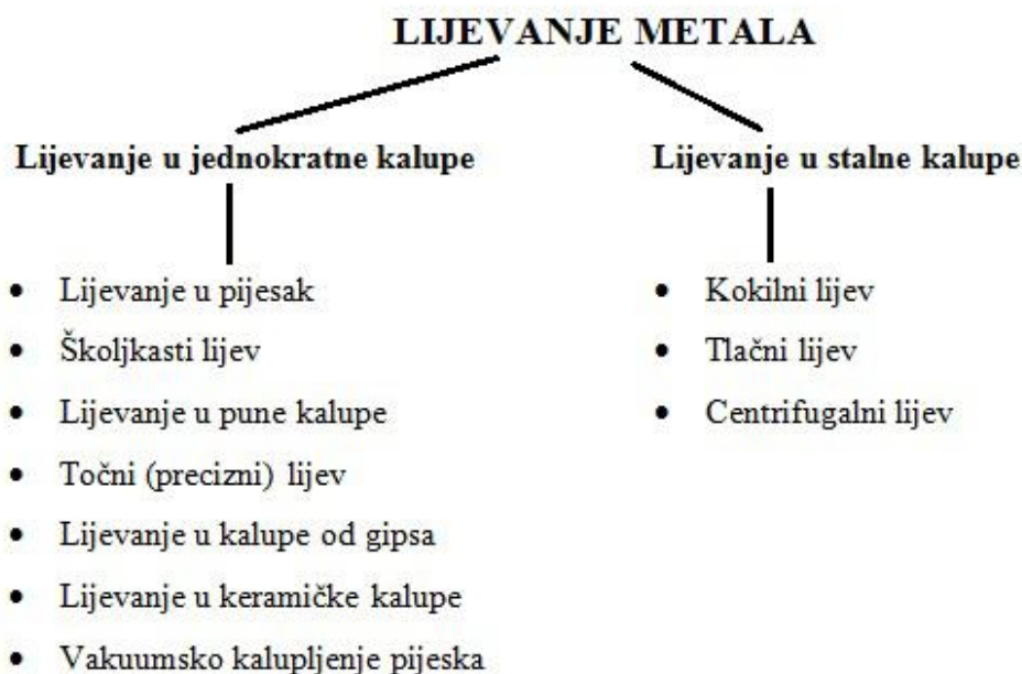
Slika 4. Podjela procesa lijevanja metala [5]
