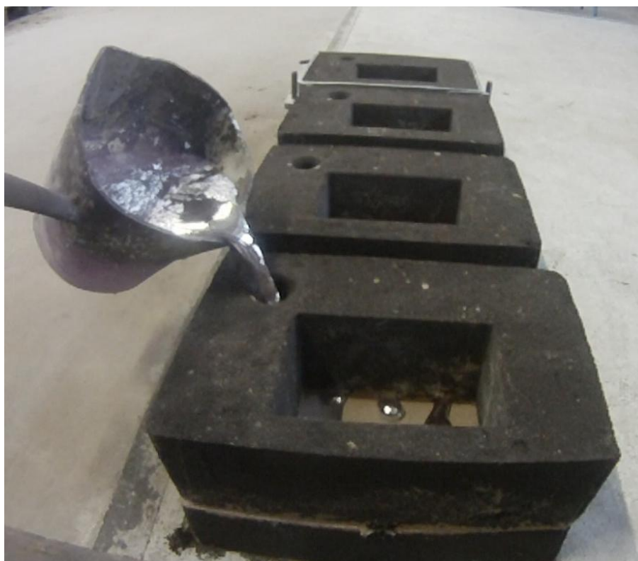
Slika 69. Lijevanje u sustav 1:2:2
