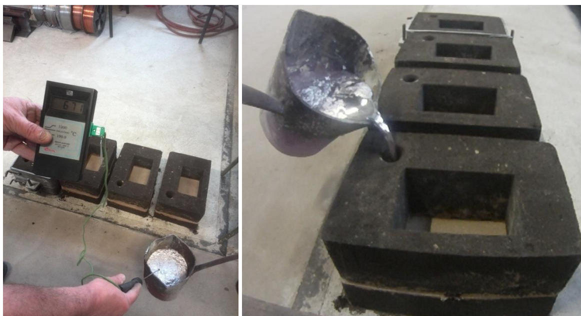
Slika 67. Mjerenje temperature kod kalupa i ulijevanje
