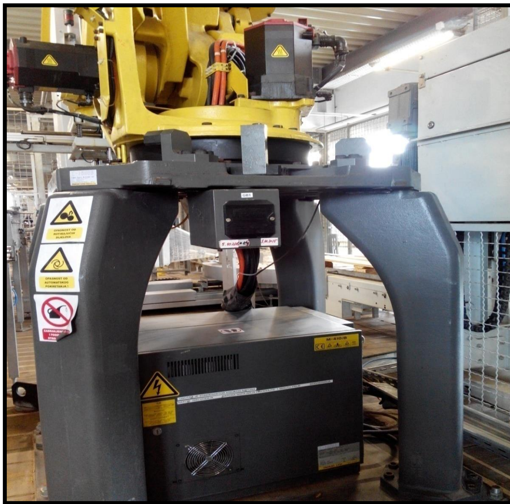
Slika 19. Zagrebačka Pivovara - stražnja strana robota za limenke. Oznake na kutiji ispod: M-410iB, E-18989
