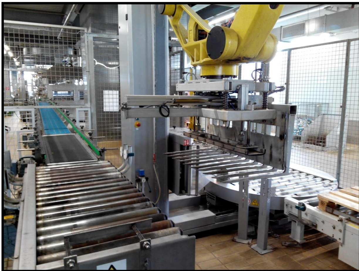
Slika 21. Zagrebačka Pivovara - slika pogona za limenke i hvataljke robota
