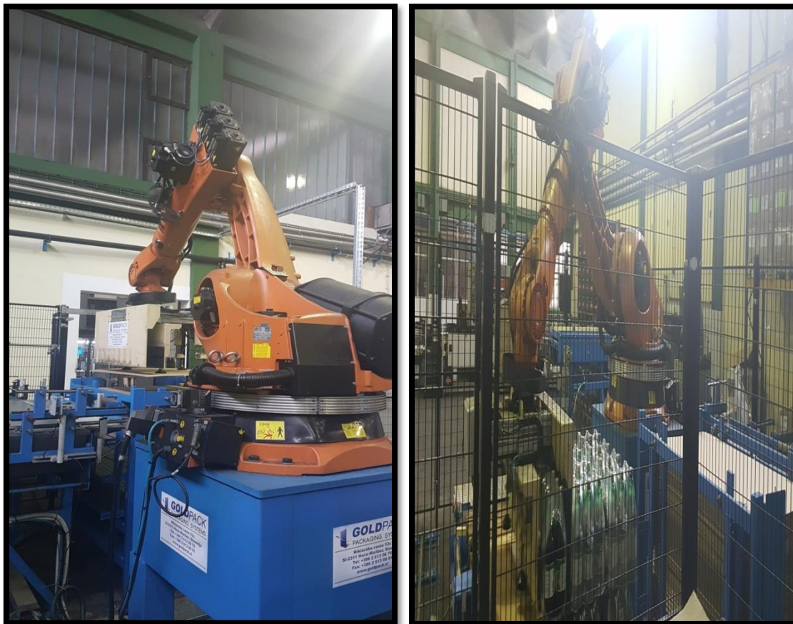
Slika 34. Istarska Pivovara - robot za paletizaciju paketa i umetanje među-rednih kartona u punionici PET boca
