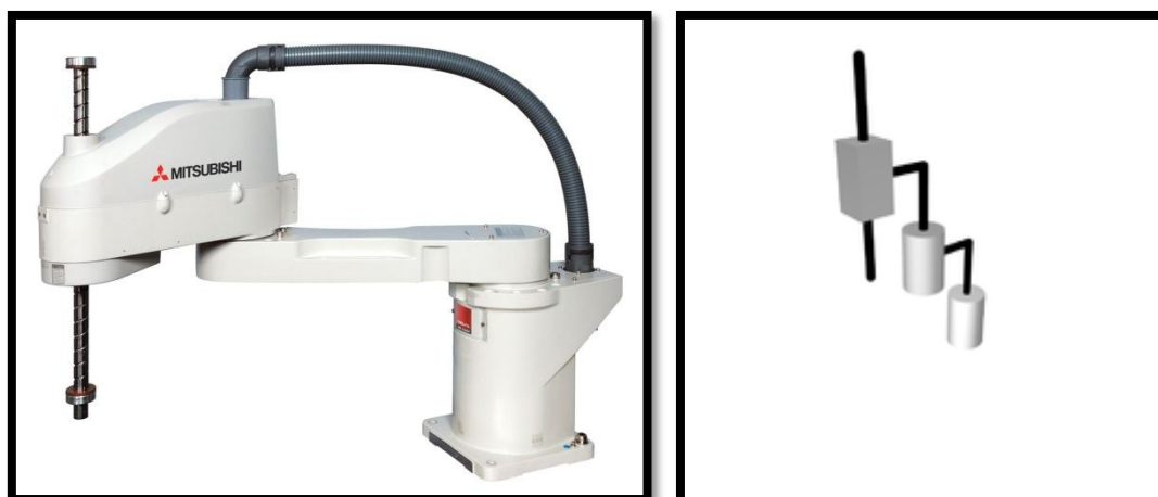
Slika 41. SCARA robot s 4 osi (lijevo), dijagram konfiguracije SCARA robota (desno)
