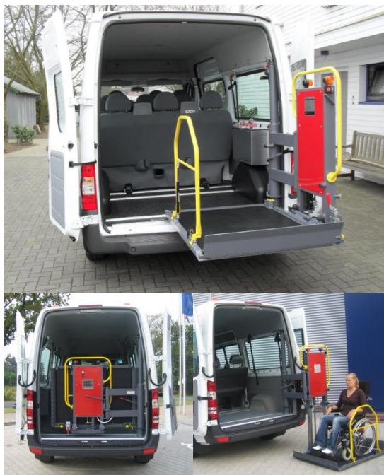
Slika 15. Swivel Lift BSL 350
