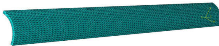
Slika 3.12: Cijev diskretizirana hibridnim tetraedarskim konačnim elementima
