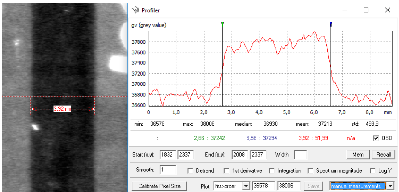
Slika 44. Mjerenje širine utora pomoću Profiler-a u zoni mjerenja 1.2 za GP 50um
