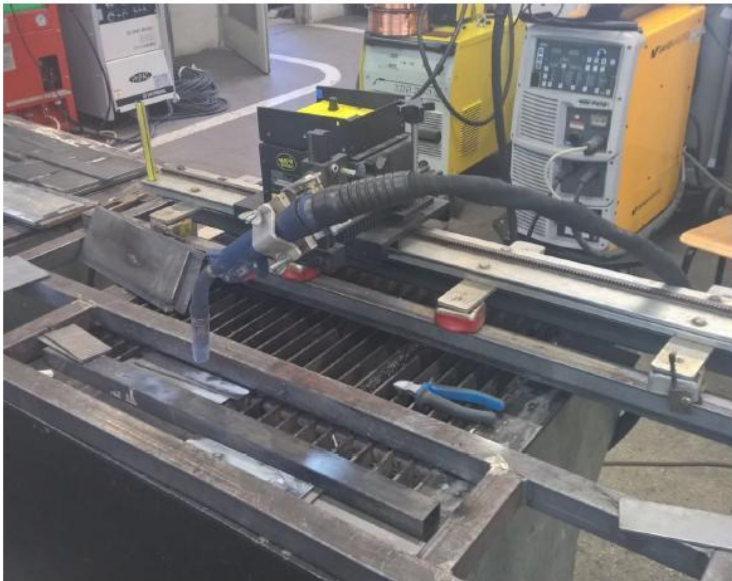
Slika 17. Uređaj za automatizirano gibanje pištolja
