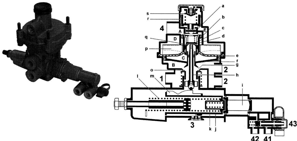
Slika 6.12 ARSK ventil za vozila sa zračnim oprugama
