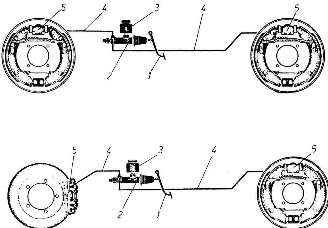
Slika 6.16 Pojednostavljena shema jednokružnog hidrauličkog kočnog sustava
