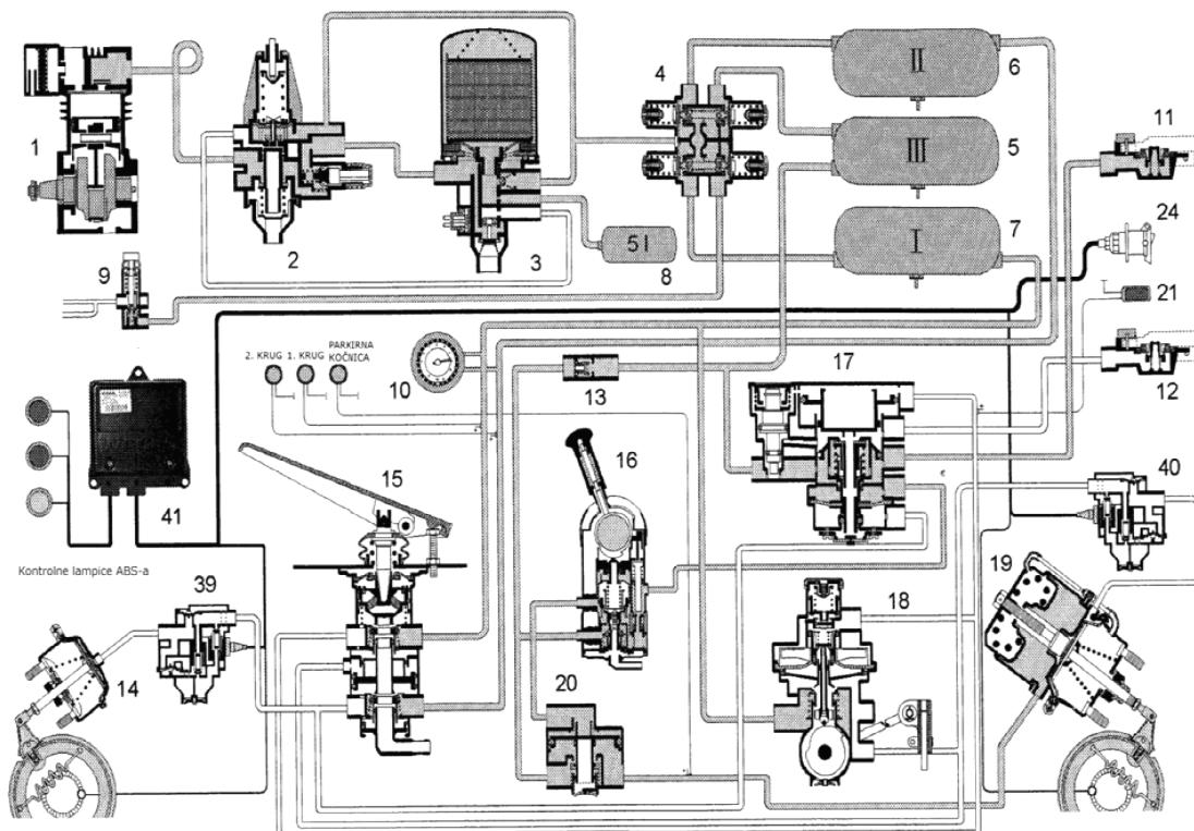
Slika 6.1 Shema zračnog kočnog sustava vučnog vozila
