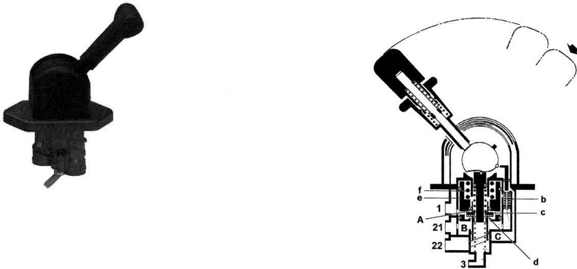
Slika 6.10 Ručni kočni ventil
