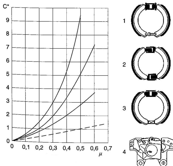
Slika 2.4 Koeficijent kočenja  $C^*$ : 1) Duo servo bubenj, 2) Duplex bubenj, 3) Simplex bubenj, 4) Disk kočnica
