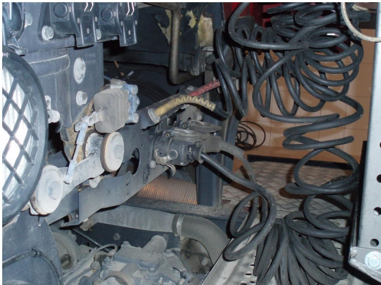
*Slika 10.2 Zračni i električni vodovi za priključno vozilo*
