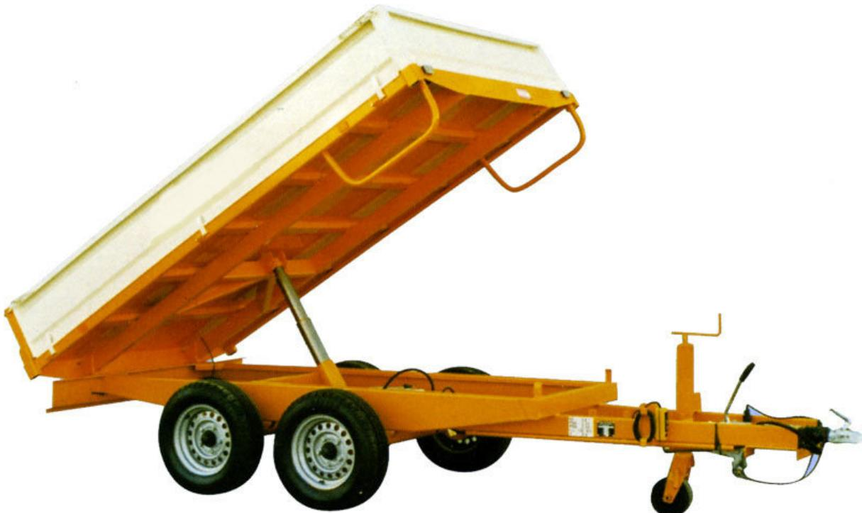
*Slika 7.4 Priključno vozilo s inercijskom kočnicom*
