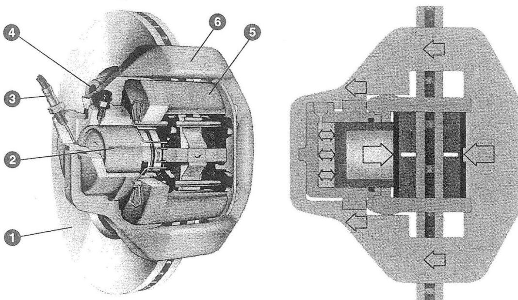
Slika 5.16 Okvirne kočne čeljusti: 1) Kočni disk, 2) Kočni klip, 3) Hidraulički vod, 4) Vijci za ispuštanje kočne tekućine, 5) Prihvati čeljusti, 6) Okvir
