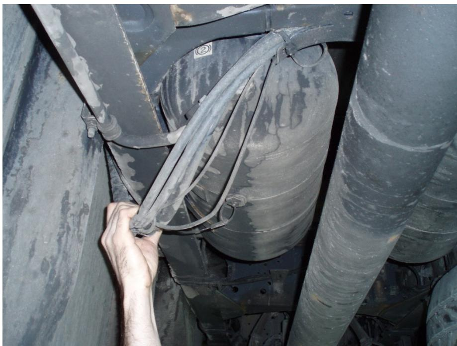
*Slika 10.5 Provjera pričvršćenosti crijeva*
