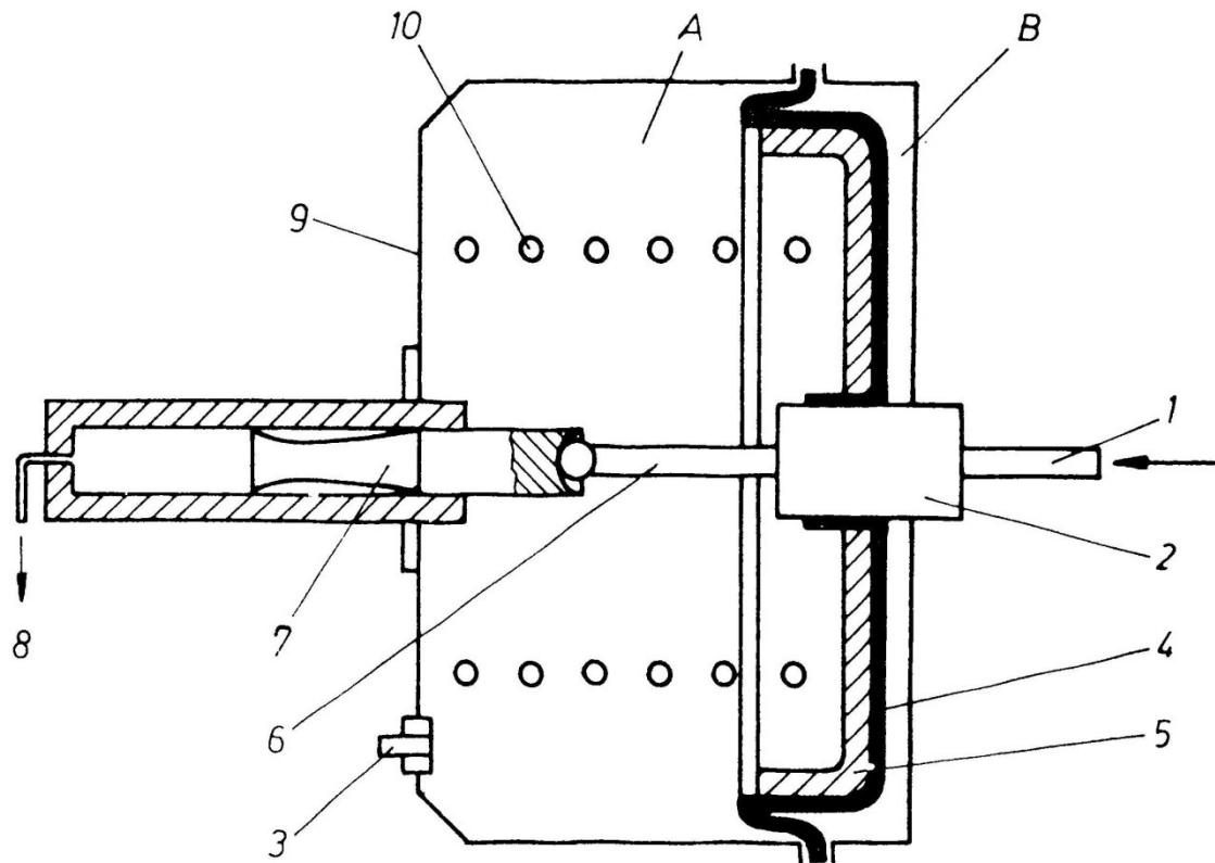
*Slika 6.22 Vakuumski servo pojačivač sile kočenja*
