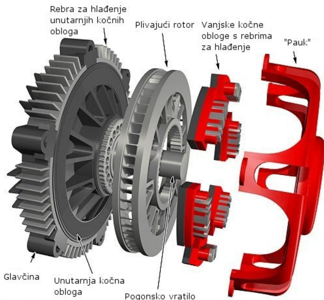
*Slika 5.13 Disk kočnice s potpunim nalijeganjem*
