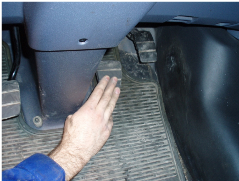
Slika 10.16 Provjera hoda papučice glavnog kočnog ventila
