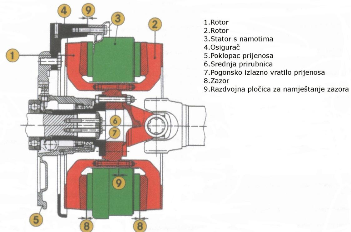
*Slika 4.6 Elektrodinamički retarder*
