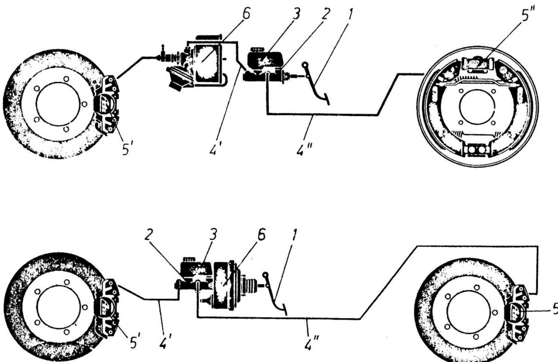
*Slika 6.21 Pojednostavljena shema hidrauličkog sustava s pojačanjem*
