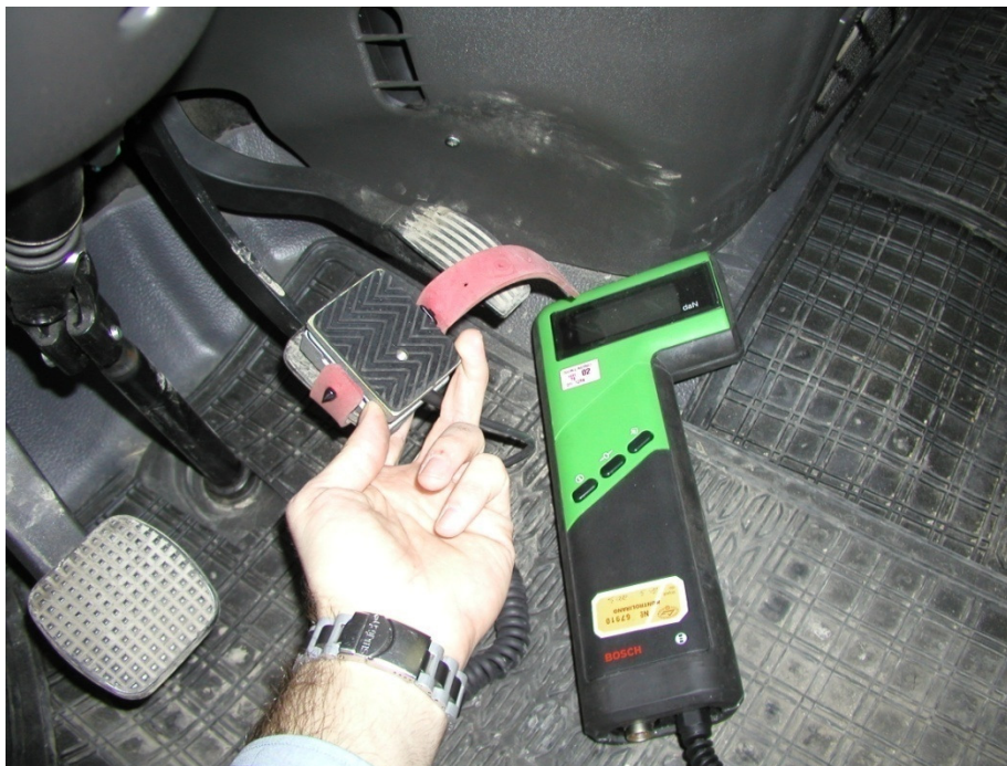
Slika 10.13 Postavljanje dinamometra na papučicu kočnice
