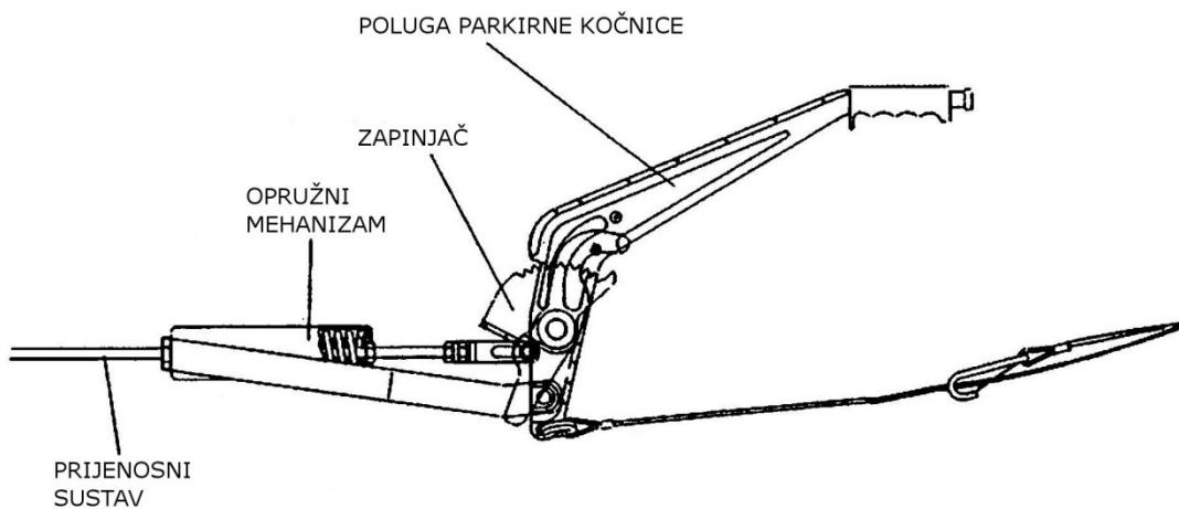
*Slika 7.10 Poluga ručne kočnice sa mehanizmom sa zapinjačem*
