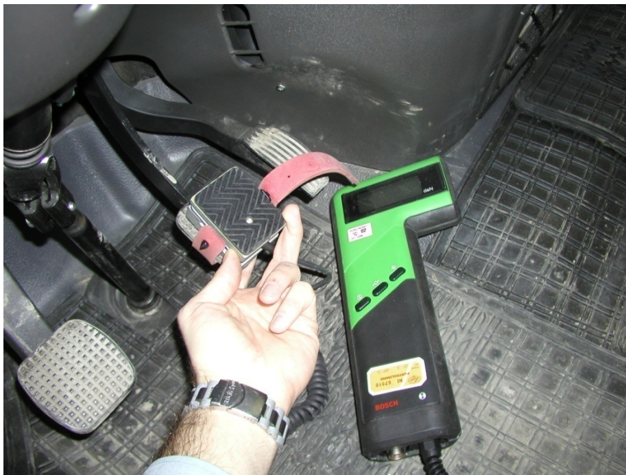
Slika 10.13 Postavljanje dinamometra na papučicu kočnice
