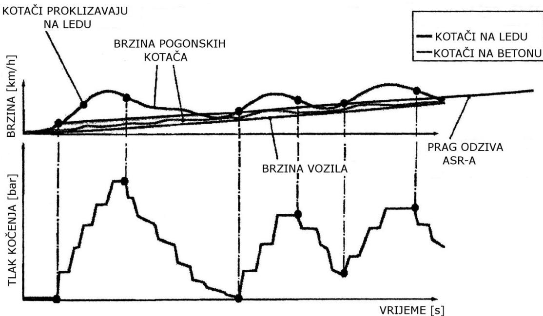
*Slika 8.5 Nadzor prianjanja kočenjem kotača*
