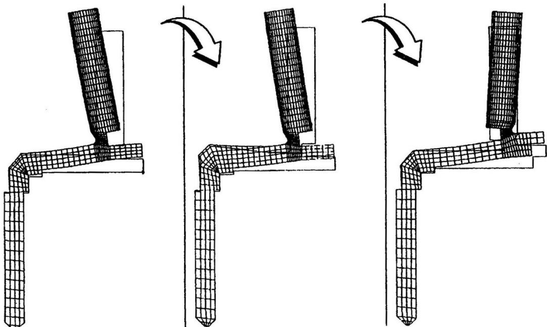
Slika 5.23 Analiza ispučenja kočnog diska zbog zagrijavanja (*engl. dishing*) metodom konačnih elemenata
