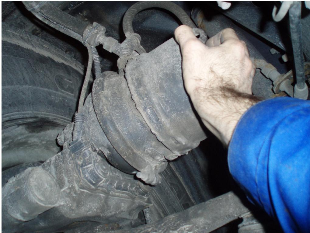
*Slika 10.9 Provjera pričvršćenosti kočnog cilindra*
