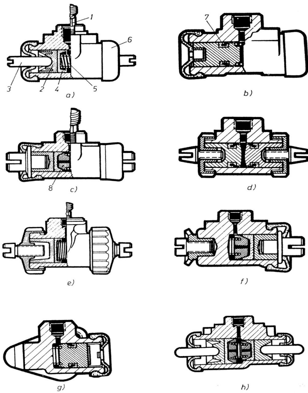
Slika 6.20 Konstrukcijska rješenja kočnih cilindara bubanj kočnica
