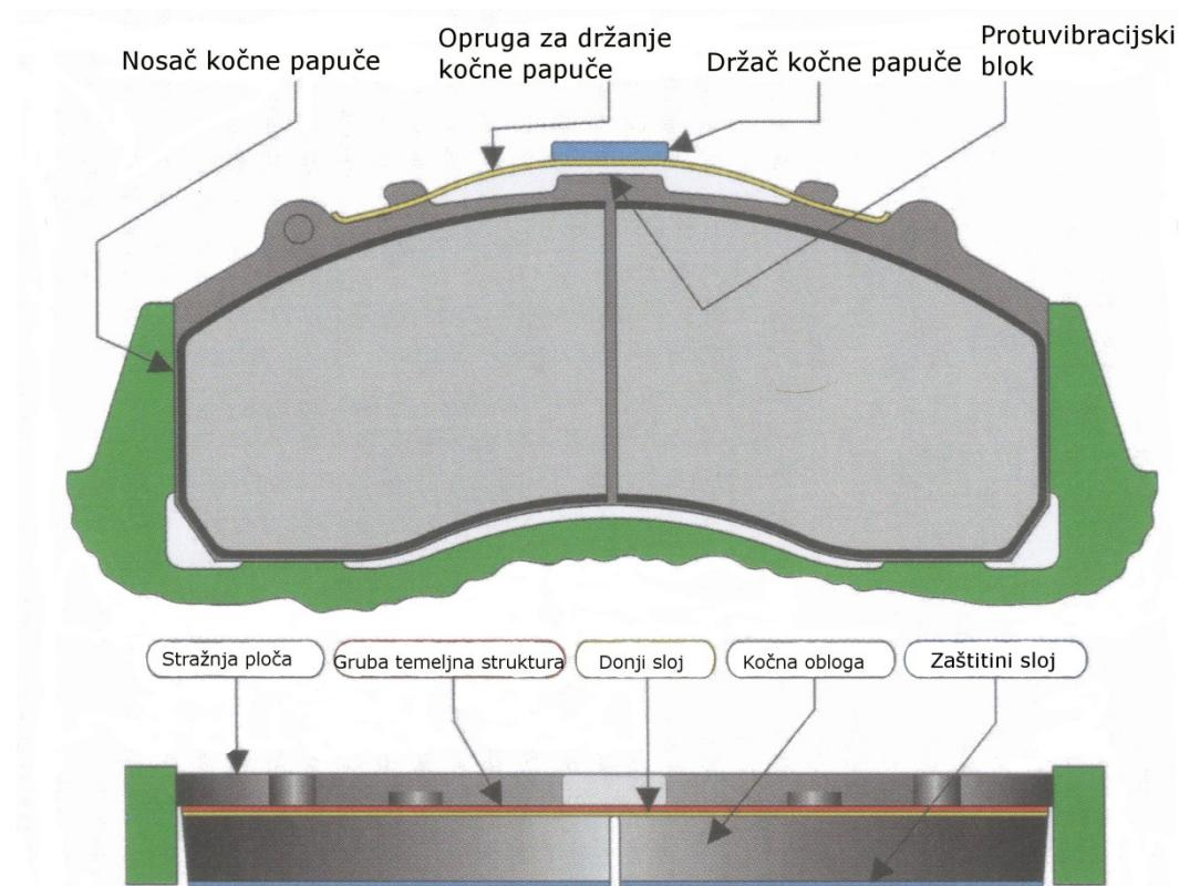
Slika 5.26 Kočna papuča disk kočnice
