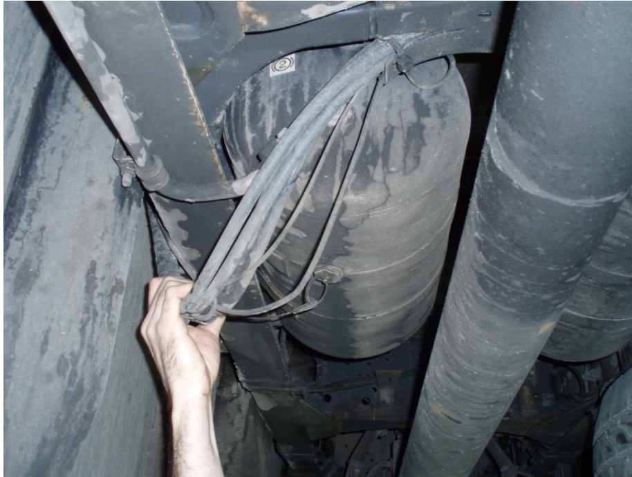
Slika 10.5 Provjera pričvršćenosti crijeva
