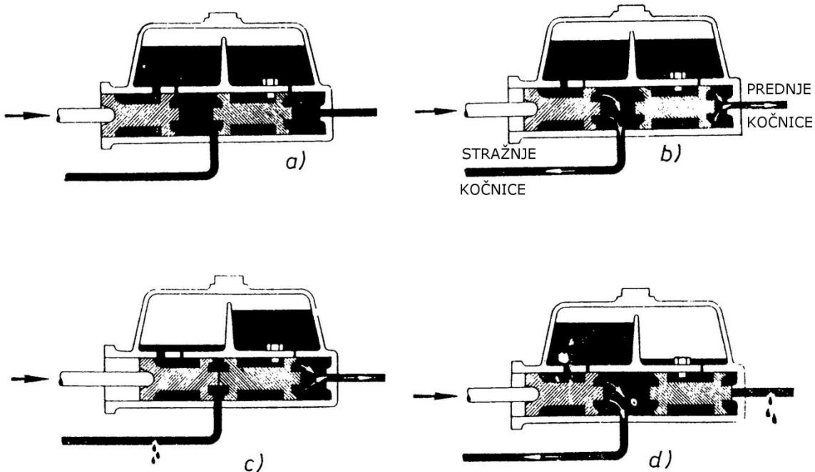
Slika 6.19 Princip rada tandem glavnog kočnog cilindra
