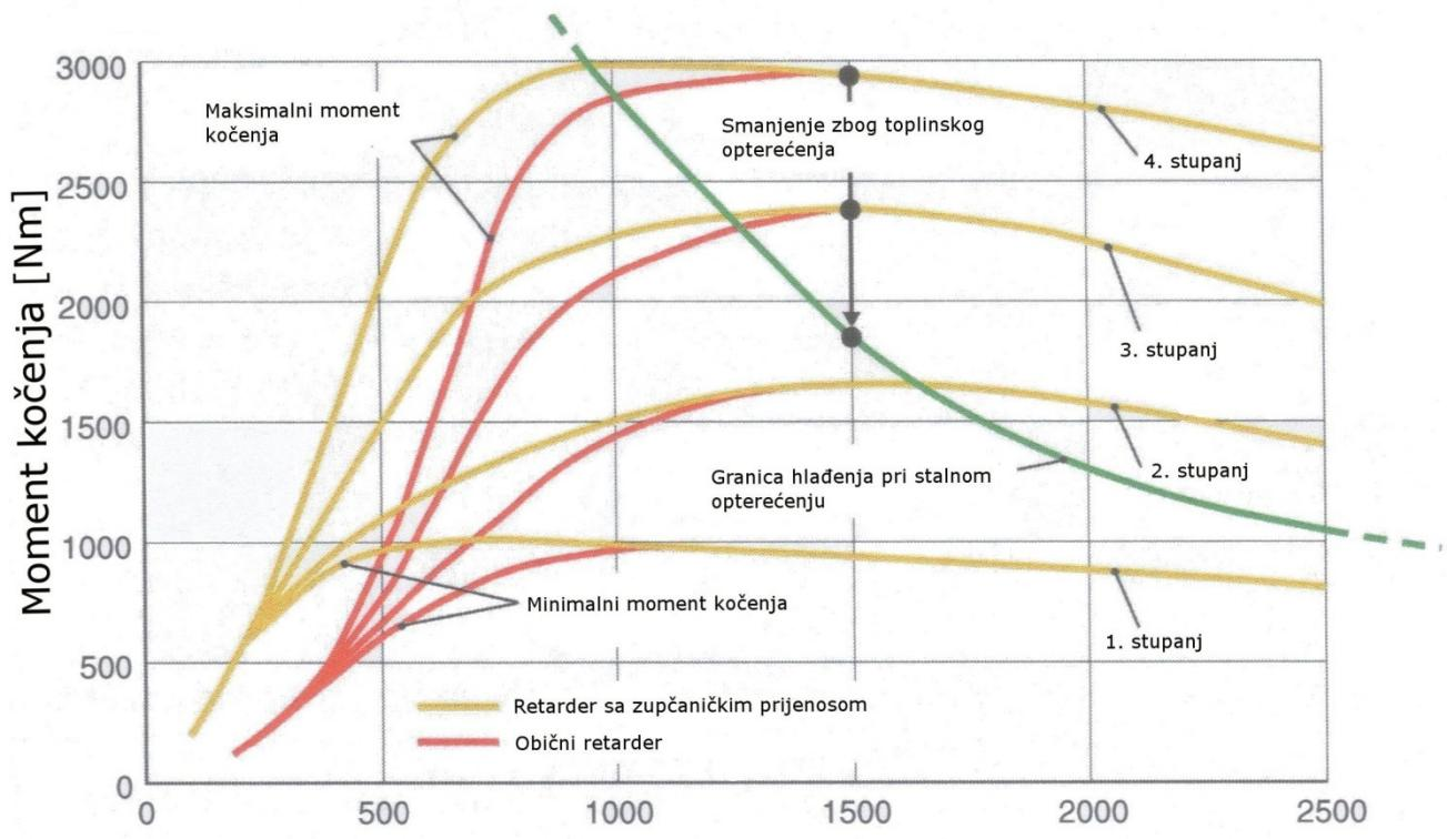
Brzina vrtnje pogonskog vratila [min<sup>-1</sup>]
