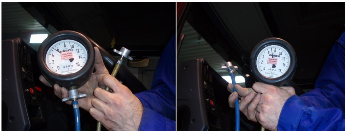
Slika 10.17 Tlak u drugom kočnom krugu kod ispraznenog prvog kruga (lijeva slika) i tlak u prvom kočnom krugu kod ispraznenog drugog kruga (desna slika)
