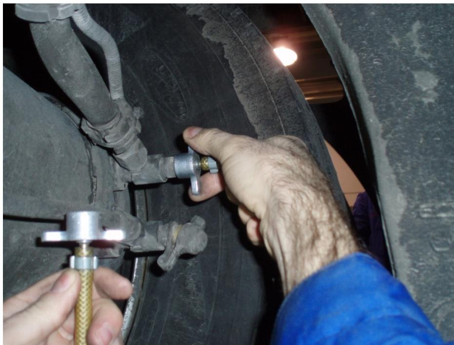
*Slika 10.12 Spajanje crijeva manometra na kontrolni priključak kočnog cilindra*
