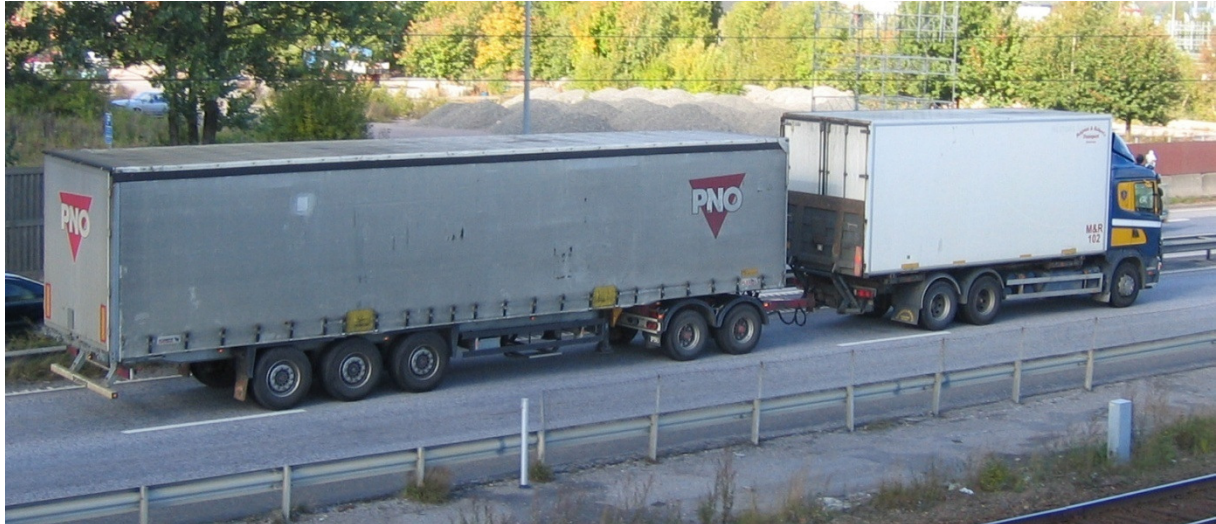
Slika 11.2 Vučna vozila najveće dopuštene mase 26 t u kombinaciji sa poluprikolicom spojenom preko kolica za teške terete
