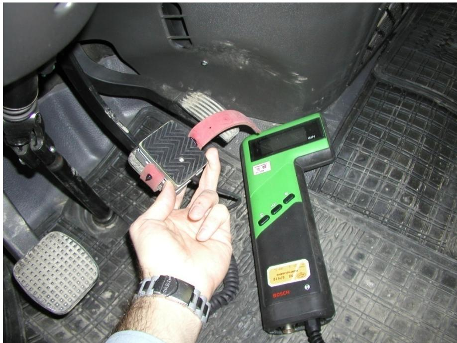
*Slika 10.13 Postavljanje dinamometra na papućicu kočnice*
