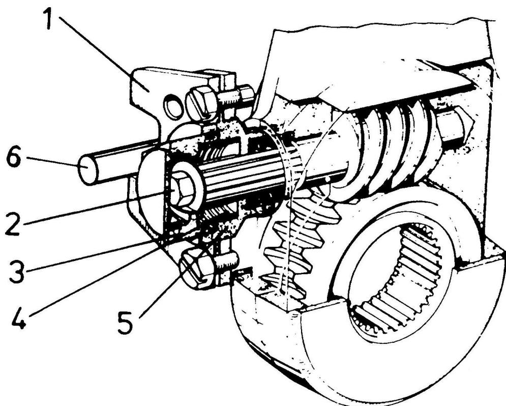
*Slika 5.11 Princip rada uređaja za automatsko podešavanje zazora*
