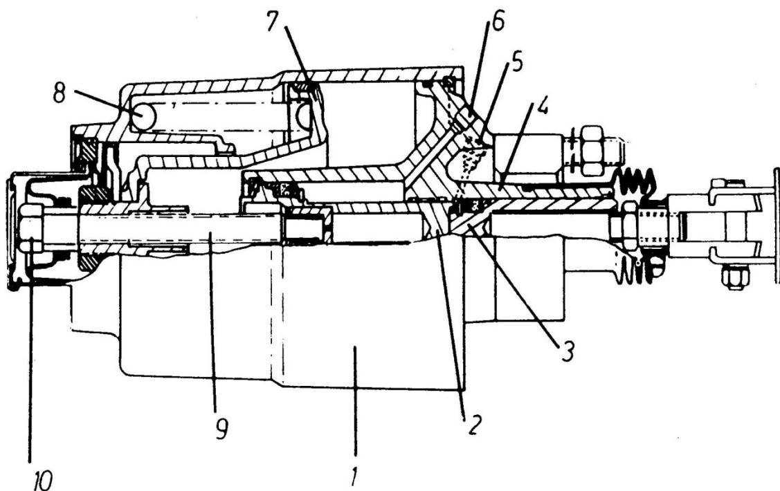
Slika 6.26 Hidraulički kočni cilindar s akumulacijskom oprugom
