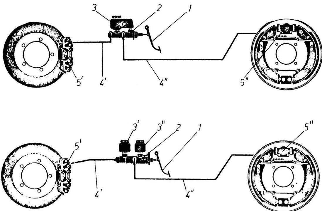
*Slika 6.17 Pojednostavljena shema dvokružnog hidrauličkog prijenosnog sustava*
