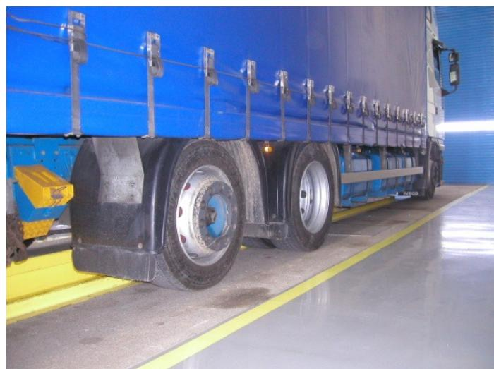
*Slika 10.24 Vozilo s jednom nekočenom osovinom*
