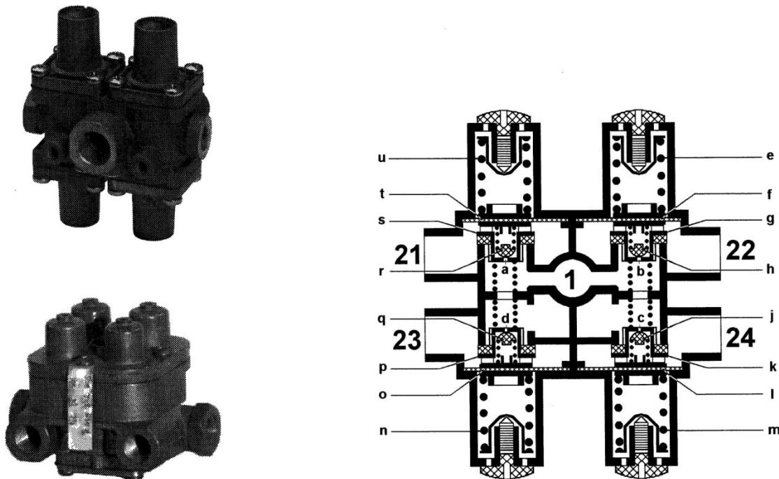
*Slika 6.5 Četverokružni ventil*
