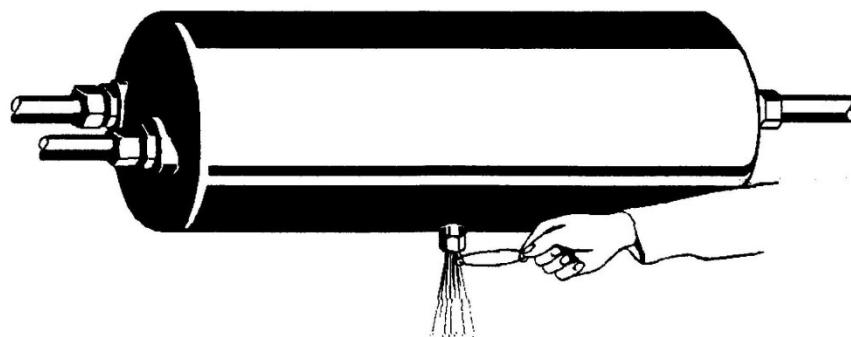
*Slika 6.6 Ispuštanje kondenzata iz spremnika zraka sa ručnim drenažnim ventilom*
