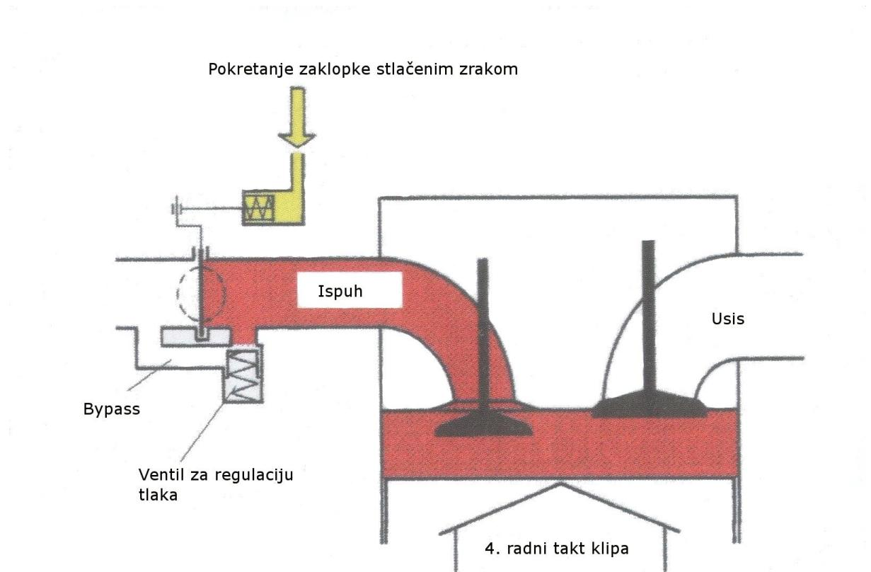
Slika 4.2 Motorna kočnica sa zaklopkom na ispušnoj cijevi
