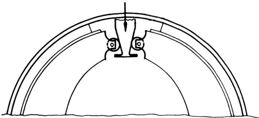
*Slika 5.6 Mehanizam s klinom za pokretanje kočnih papuča*
