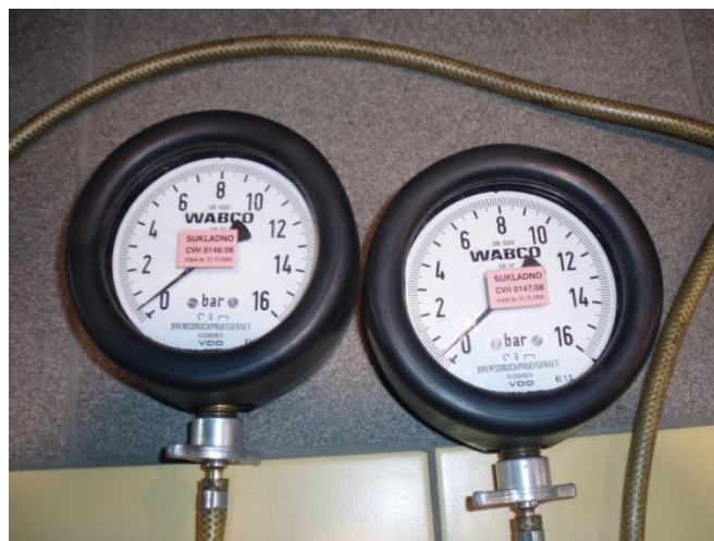
Slika 10.19 Razlika u tlakovima u radnim kočnim cilindrima prednje i stražnje osovine
