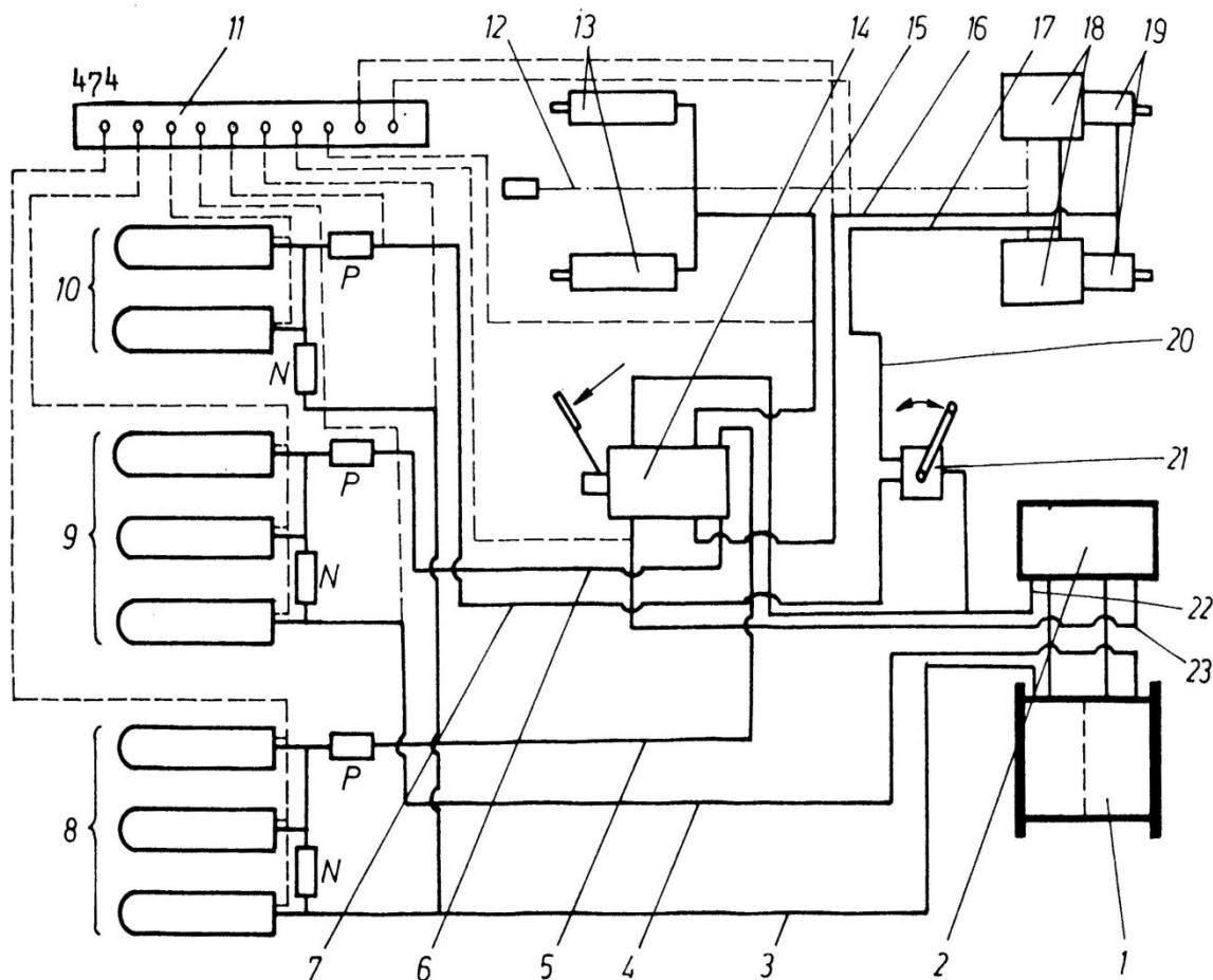
Slika 6.25 Shema hidrauličkog kočnog sustava autobra
