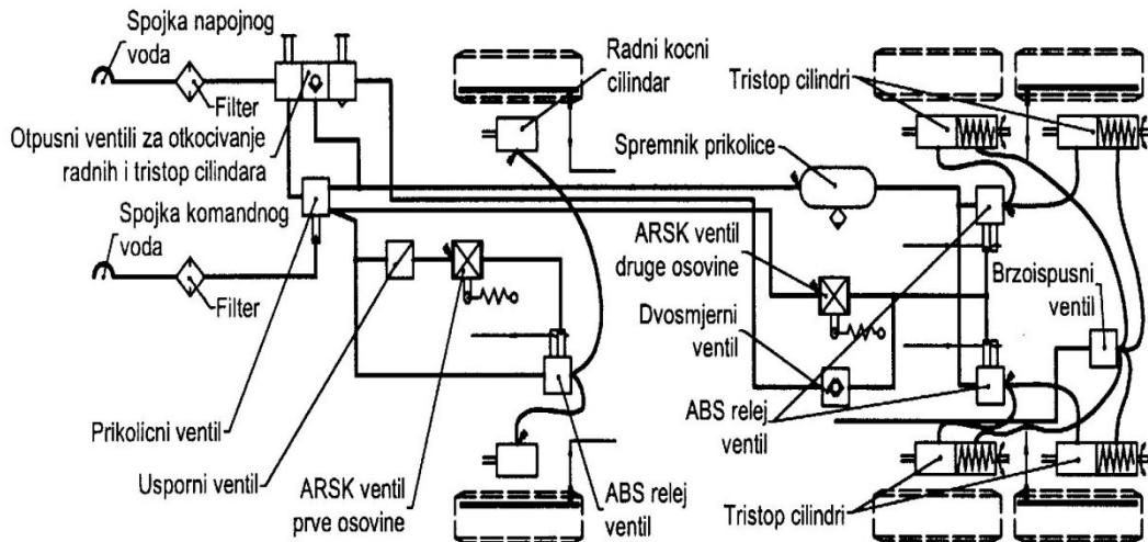
*Slika 7.1 Primjer zračna instalacija priključnog vozila (prikolice)*
