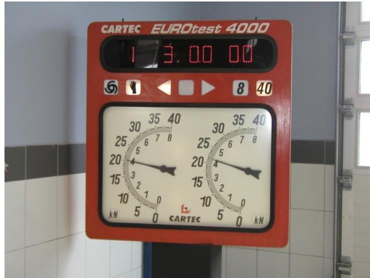
*Slika 10.23 Prikaznik uređaja za mjerjenje sile kočenja*
