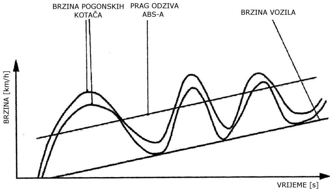
*Slika 8.4 Rad ASR - a s nadzorom rada motora na zaledjenom kolniku*
