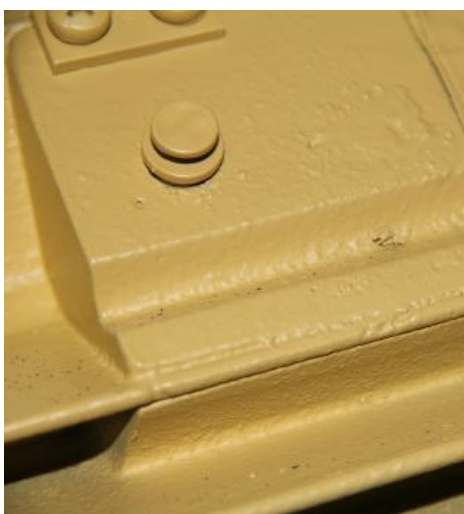
Slika 7. Zaostala prašina prije nanošenja boje
