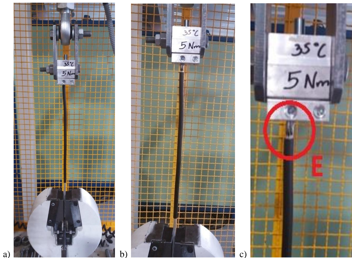
Slika 27. Ispitivanje uzorka na kidalici: a) pozicionirani uzorak prije ispitivanja, b) uzorak nakon ispitivanja, c) detalj veze vodiča i stezaljke
