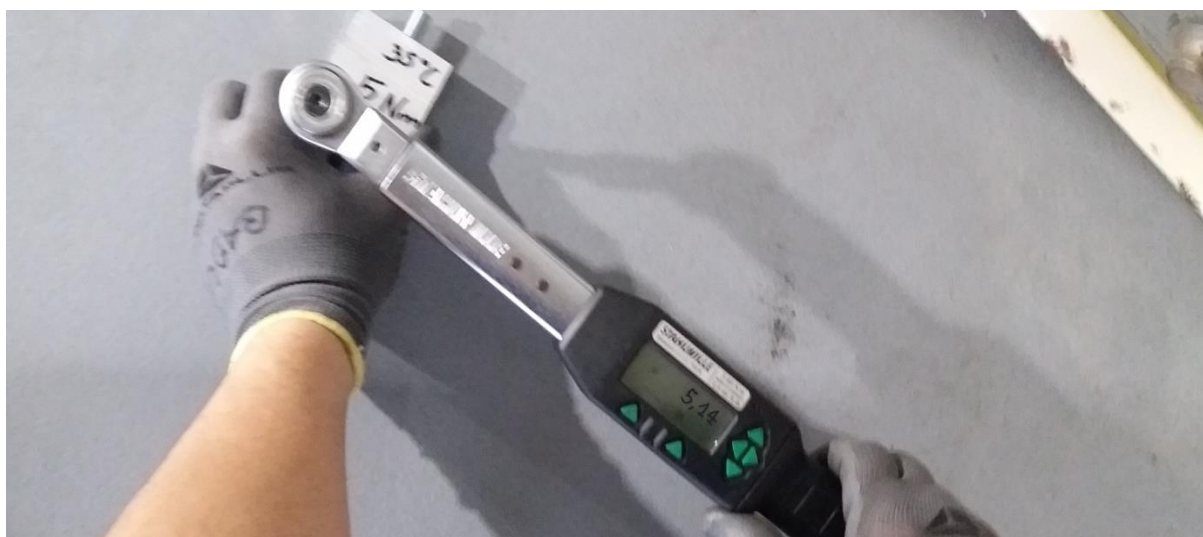
Slika 26. Pritezanje vijaka stezaljke moment ključem
