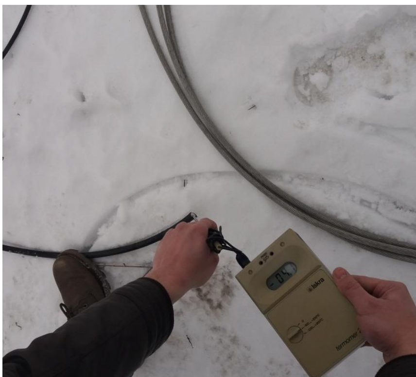
Slika 17. Mjerenje temperature vodiča
