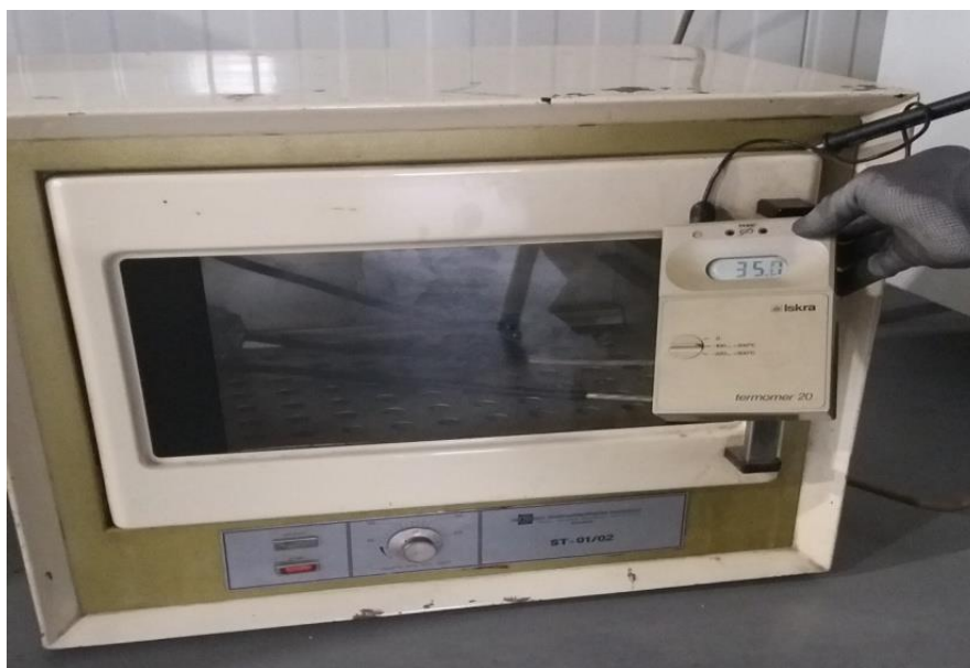
Slika 25. Komora za zagrijavanje uzoraka
