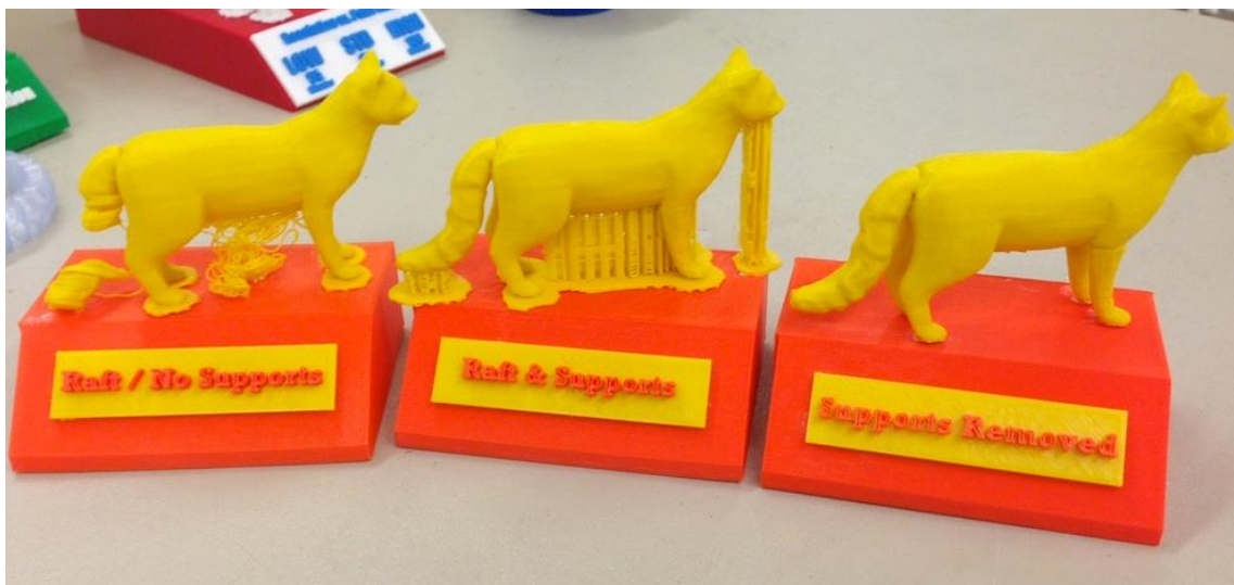
Slika 9. Prikaz predmeta s i bez potporne strukture [24]
