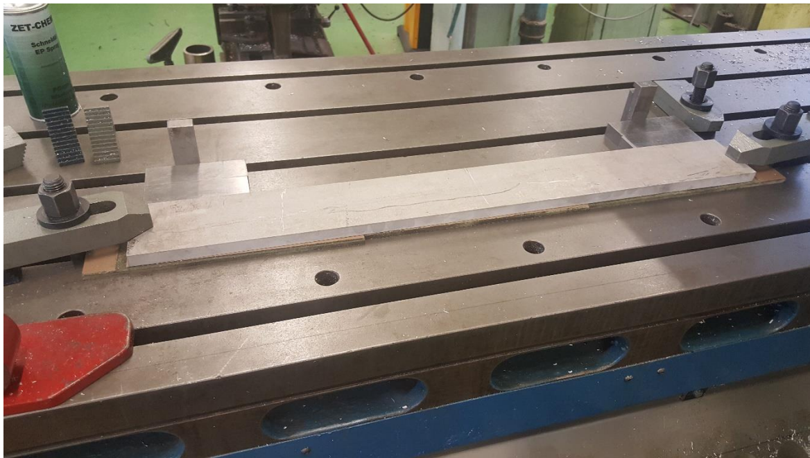
Slika 61. Stezanje sirovca na stroj
