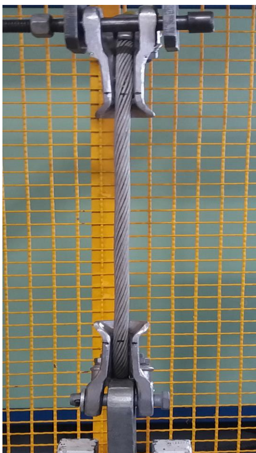
Slika 24. Ispitivanje na kidalici: a) prihvat uzorka na kidalici, b) izvlačenje vodiča iz stezaljke
