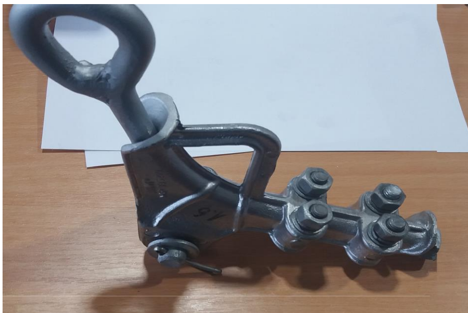
Slika 36. Uzorak s odgovarajućim alatom pritegnut s 25 Nm
