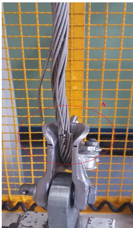
Slika 34. Ispitivanje na kidalici: a) uzorak prije ispitivanja, b) popuštanje vodiča na izlazu iz stezaljke
