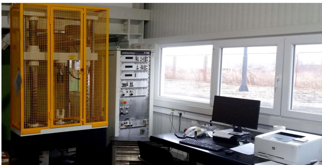
Slika 5. Statička kidalica s pripadajućom upravljačkom jedinicom
