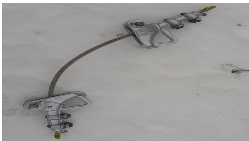
Slika 23. Uzorak za ispitivanje sile izvlačenja vodiča
