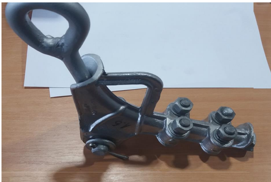
Slika 36. Uzorak s odgovarajućim alatom pritegnut s 25 Nm
