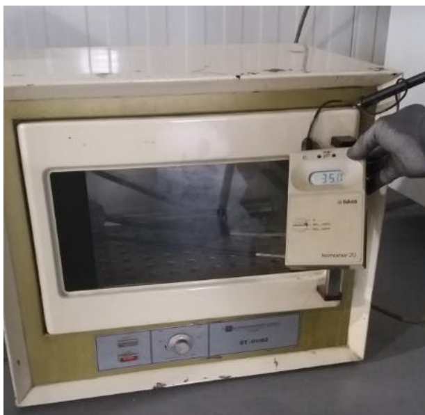
Slika 6. Komora za zagrijavanje ispitnih uzoraka
