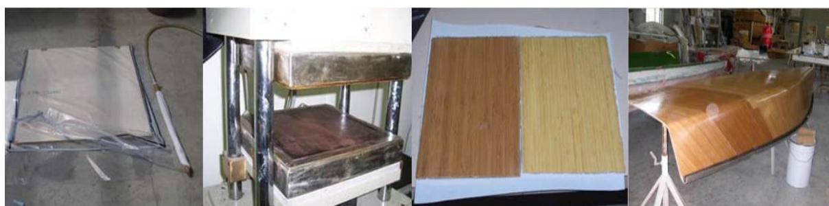
Slika 4.5. Proces ispitivanja trupa broda od kompozita s bambusovim vlaknima namijenjen za vodene sportske aktivnosti [11]
