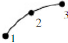
Slika 20. Gredni konačni element B22 [5]
