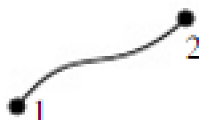
Slika 18. Gredni konačni element B23 [5]
